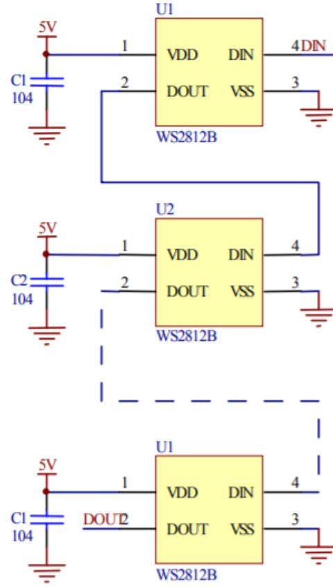
**Slika 5.1. Shema spajanja WS2812B LE dioda**
