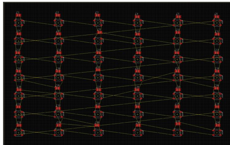
**Slika 5.4. Primjer poredanih komponenti na tiskanoj pločici**
