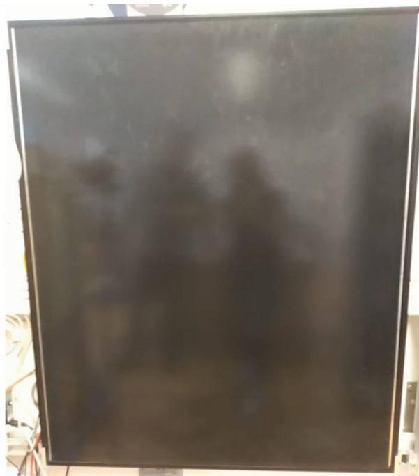
**Slika 2.7. Fotonaponski modul – amorfni silicij**
