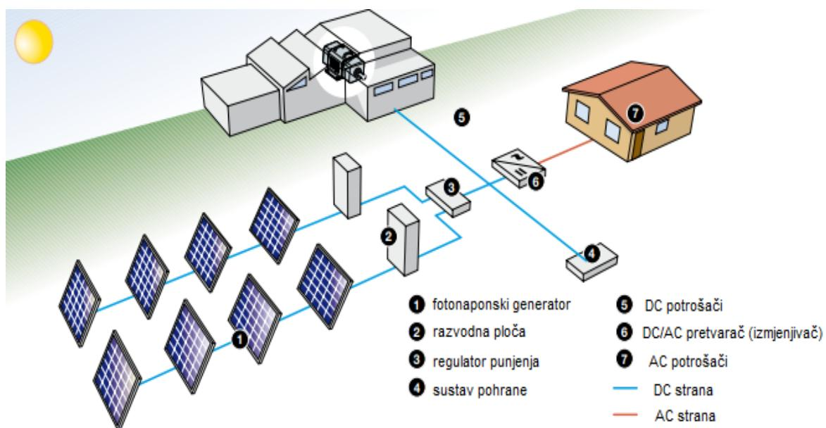
Slika 2.8. Samostalni fotonaponski sustav [1]
