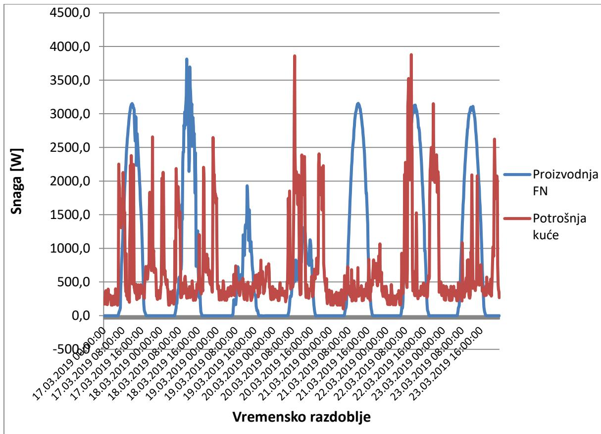
Slika 4.2. Dijagram proizvodnje fotonaponske elektrane i potrošnje kuće
