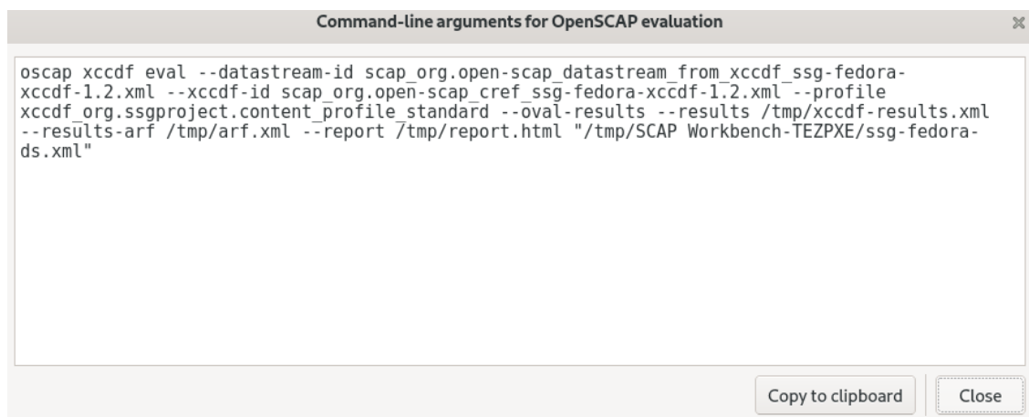
Slika 3.18. Naredba za skeniranje sustava pomoću naredbenog retka
