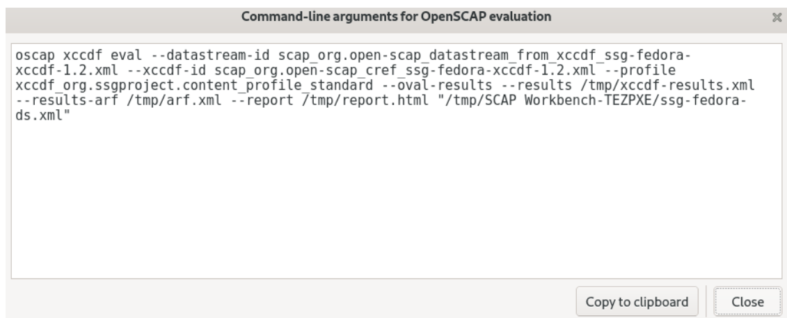
Slika 3.18. Naredba za skeniranje sustava pomoću naredbenog retka
