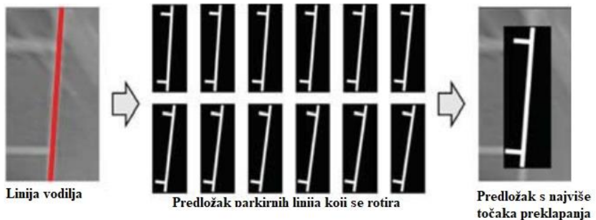
Sl. 2.3. Procjena položaja parkin ga pomoću rotiranja predloška [3]
