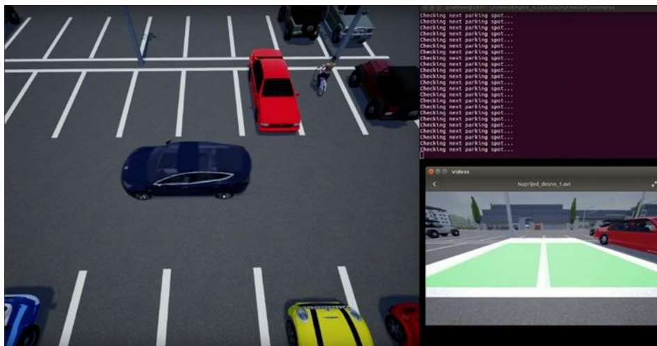
Sl. 3.39. Primjer iz simulatora - vozilo traži slobodan parking i provjerava njemu susjedni parking
