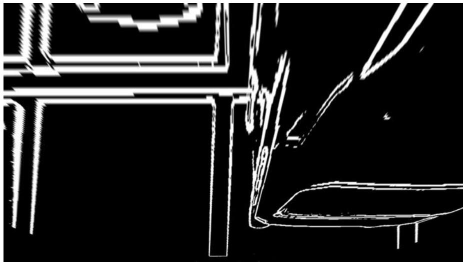
**Sl. 3.15.** Izlazni okvir nakon primjene Sobelovog operatora i transformacije perspektive
