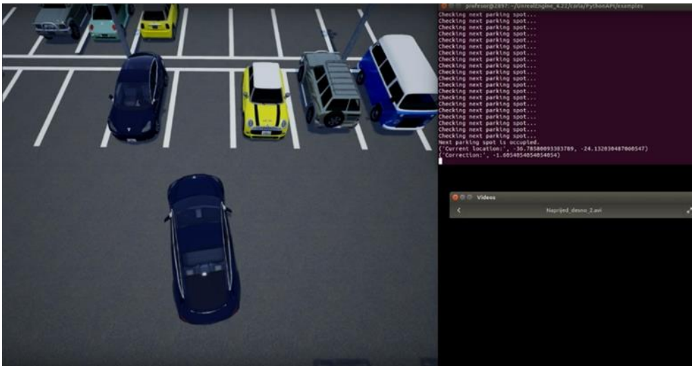
Sl. 3.37. Primjer iz simulatora - vozilo se vraća unatrag kako se ne bi sudarilo sa susjednim vozilom
