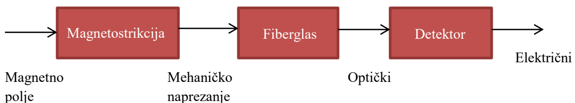
Slika 2.9. Shema senzora fiberoptičkog magnetnog polja
