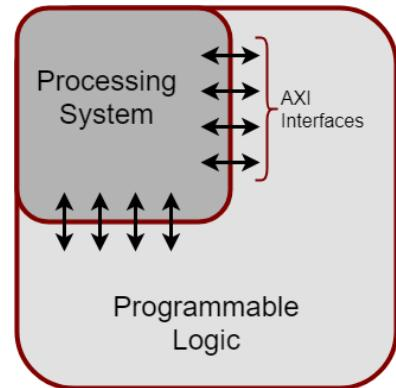
Slika 2.14.: Pojednostavljeni model Zynq arhitekture. [17]
