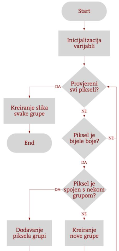
Slika 3.5.: Dijagram toka modificiranog CCL algoritma.
