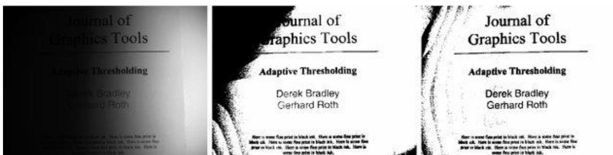
Slika 2.22.: Usporedba Wellnerove metode (sredina) i Bradley Adaptive Threshold algoritma (desno) primijenjenih na slici (lijevo).[28]
