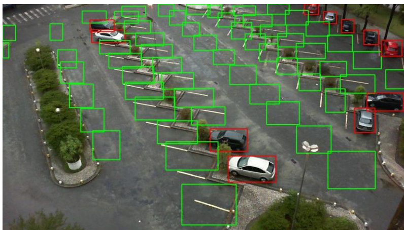
Sl. 3.14. Prikaz klasifikacije parkirnih mjesta na zauzeta (crvena boja) i slobodna (zelena boja).
