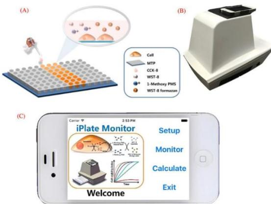
Slika 4.5. A) Konstrukcija održivosti senzora , b) Slika pametno-prijenosnog koncipiranog uređaja i C) glavno sučelje kućno baziranog softvera IPlate zaslona.
