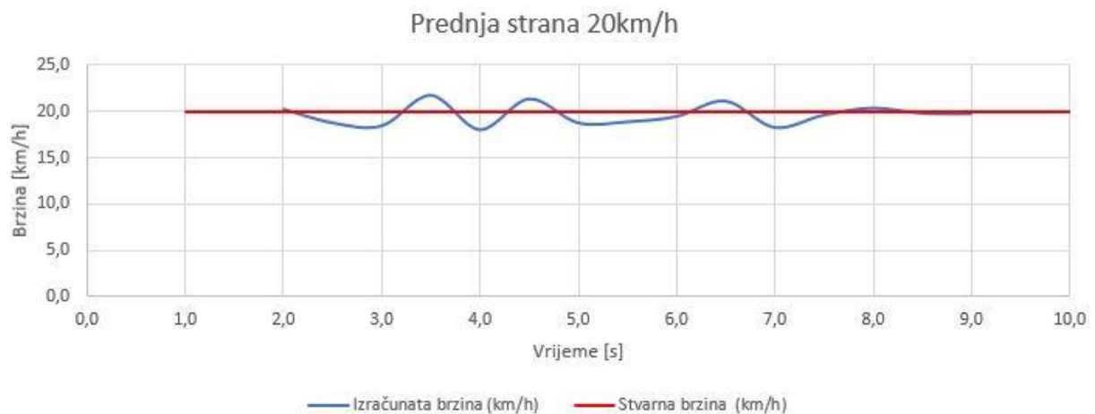
Slika 4.53. Prikaz brzine za prednju stranu automobila pri brzini 20km/h
