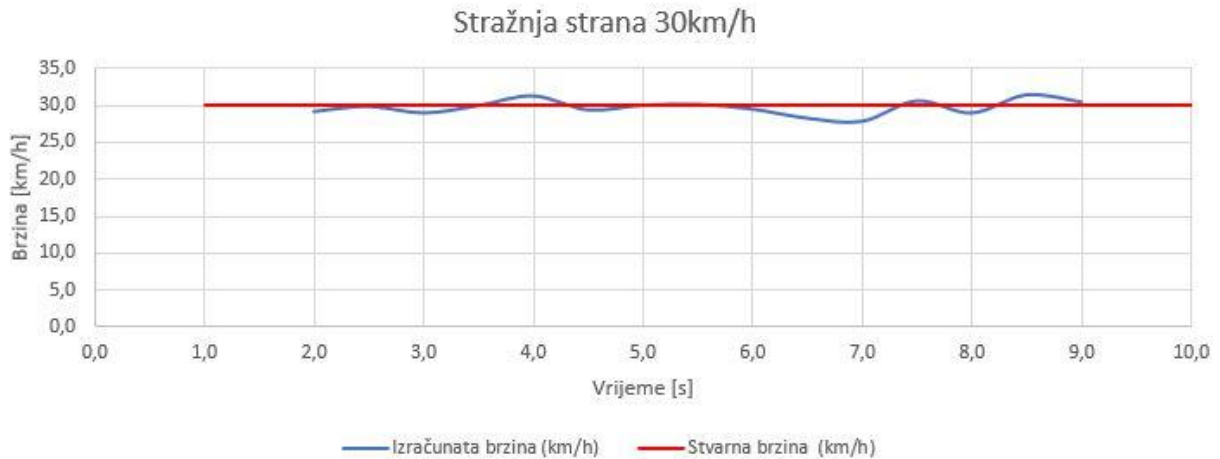
Slika 4.57. Prikaz brzine za stražnju stranu automobila pri brzini 30km/h
