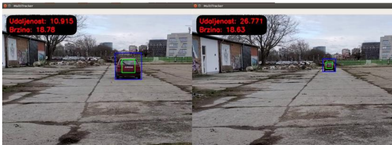
Slika 3.18. Brzina kretanja detektiranog vozila iznosi 20 km/h
