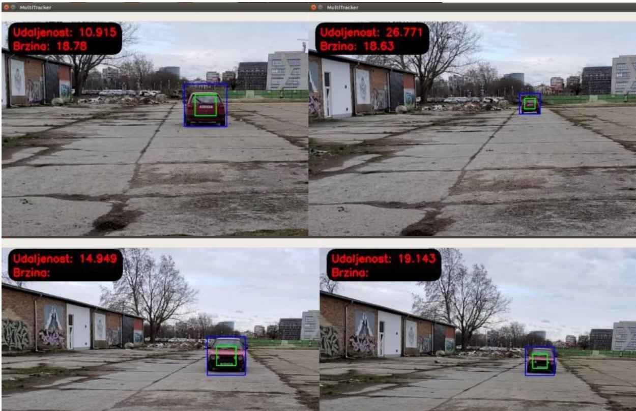
Slika 3.17. Prikaz 4 različite udaljenosti detektiranog automobila (5, 10, 15 i 20 m)
