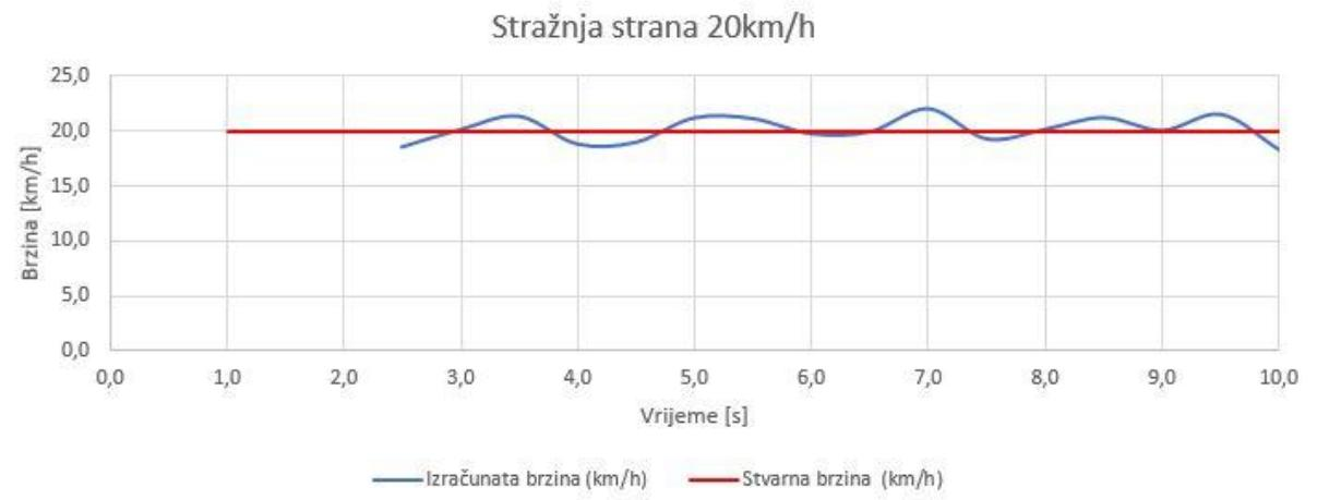
Slika 4.56. Prikaz brzine za stražnju stranu automobila pri brzini 20km/h
