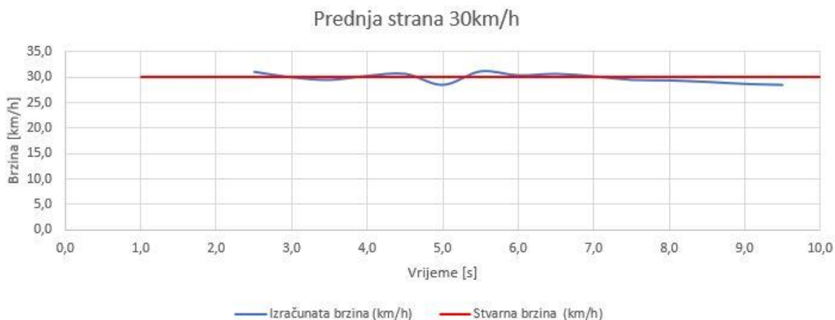
Slika 4.54. Prikaz brzine za prednju stranu automobila pri brzini 30km/h
