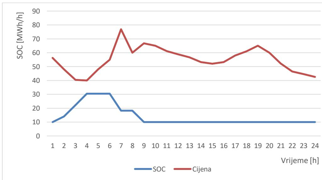
Slika 6.10 Ovisnost stanja napunjenosti baterije o očekivanoj cijeni električne energije za  $\eta_1=0,85$   $\eta_2=0,75$
