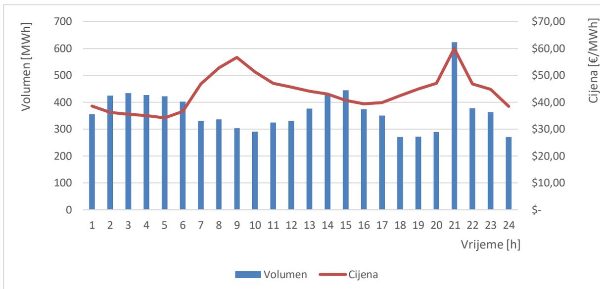
Slika 4.6 Dijagram ovisnosti cijene električne energije o volumenu
