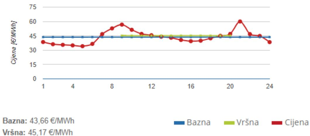
Slika 4.4 Dijagram promjene cijene električne energije za dan 29.4.2019. [9]
