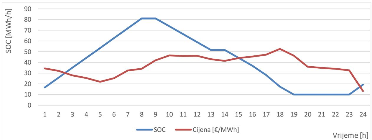
Slika 6.3 Ovisnost stanja napunjenosti baterije o očekivanoj cijeni električne energije za dan 14.12.2019.
