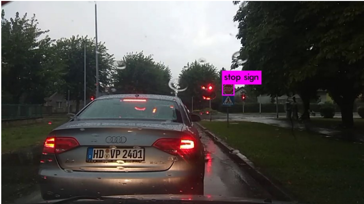
Sl. 4.2. Primjer FN detekcije po kišnom vremenu pri detekciju semafora s uključenim crvenim svjetlom.
