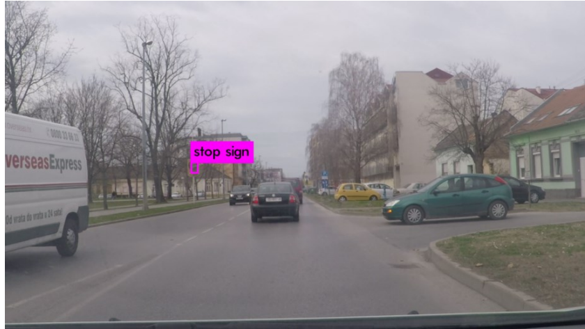
SI.3.12. Detekcija nepoznatog objekta pored ceste kao znaka obaveznog zaustavljanja.
