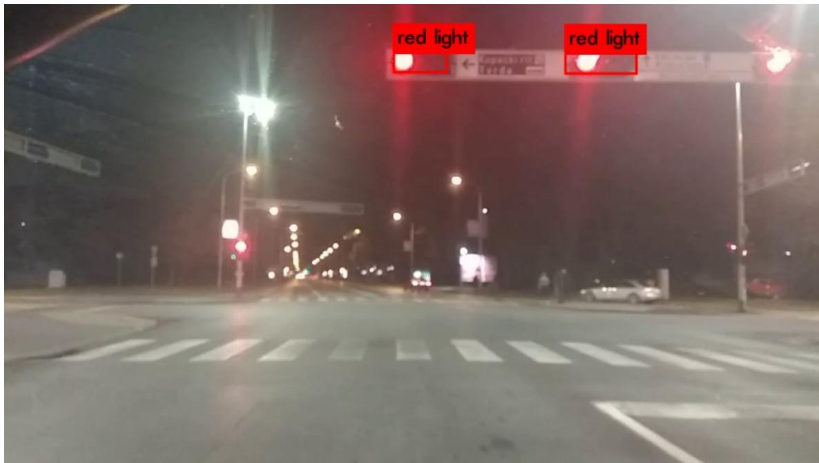
**Sl. 4.1.** Primjer FN u noćnim uvjetima pri detekciji semafora s uključenim crvenim svjetлом.
