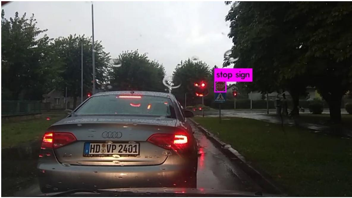
**Sl. 4.2.** Primjer FN detekcije po kišnom vremenu pri detekciji semafora s uključenim crvenim svjetlom.
