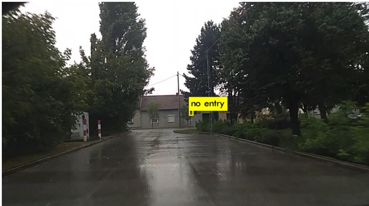
**Sl. 4.6.** Primjer FP detekcije po kišnom vremenu.
