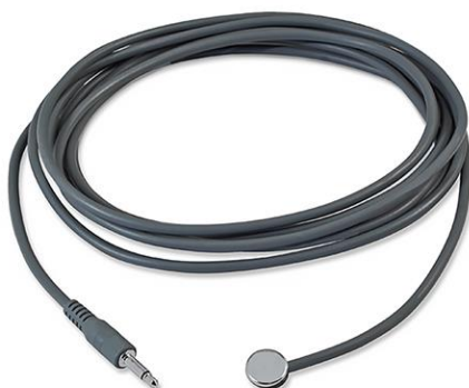
Sl. 4.9 Senzor za mjerenje tjelesne temperature [17]
