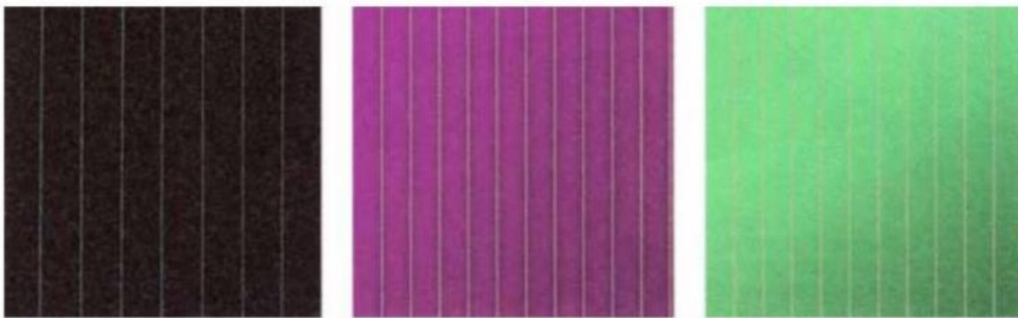
Slika 3.2 Solarna ćelija od bakar-indij-diselenida (CIS) (lijevo), amorfna silicijeva ćelija (sredina) te solarna ćelija od kadmijeva telurida (CdTe) (desno) [3]
