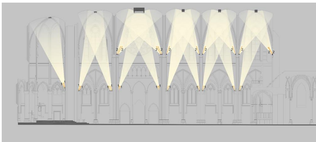
Slika 6.33 Skica načelnih pozicija rasvjetnih tijela sa usmjerenjima snopova svjetlosti, za rasvjetu svodova srednje i visoke razine
