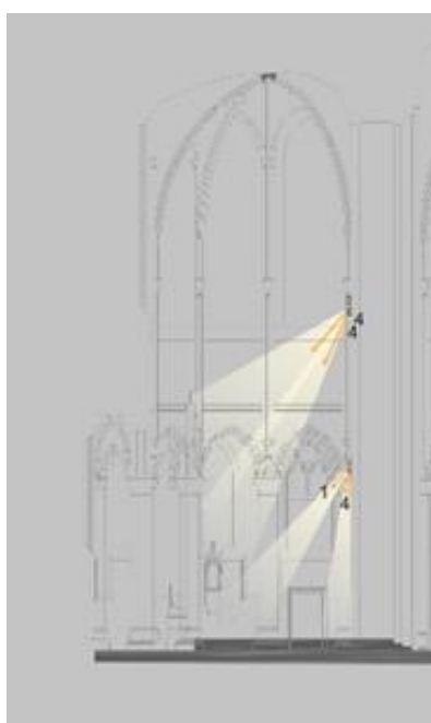
Slika 6.8 Prikaz načelnih pozicija rasvjetnih tijela i snopova svjetlosti za glavni oltar (gledano bočno)
