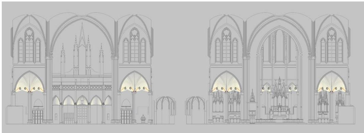
Slika 6.35 Skica načelnih pozicija rasvjetnih tijela sa usmjerenjima snopova svjetlosti, za rasvjetu svodova najniže razine (gleđano prema naprijed i prema natrag sa središta prostora)
