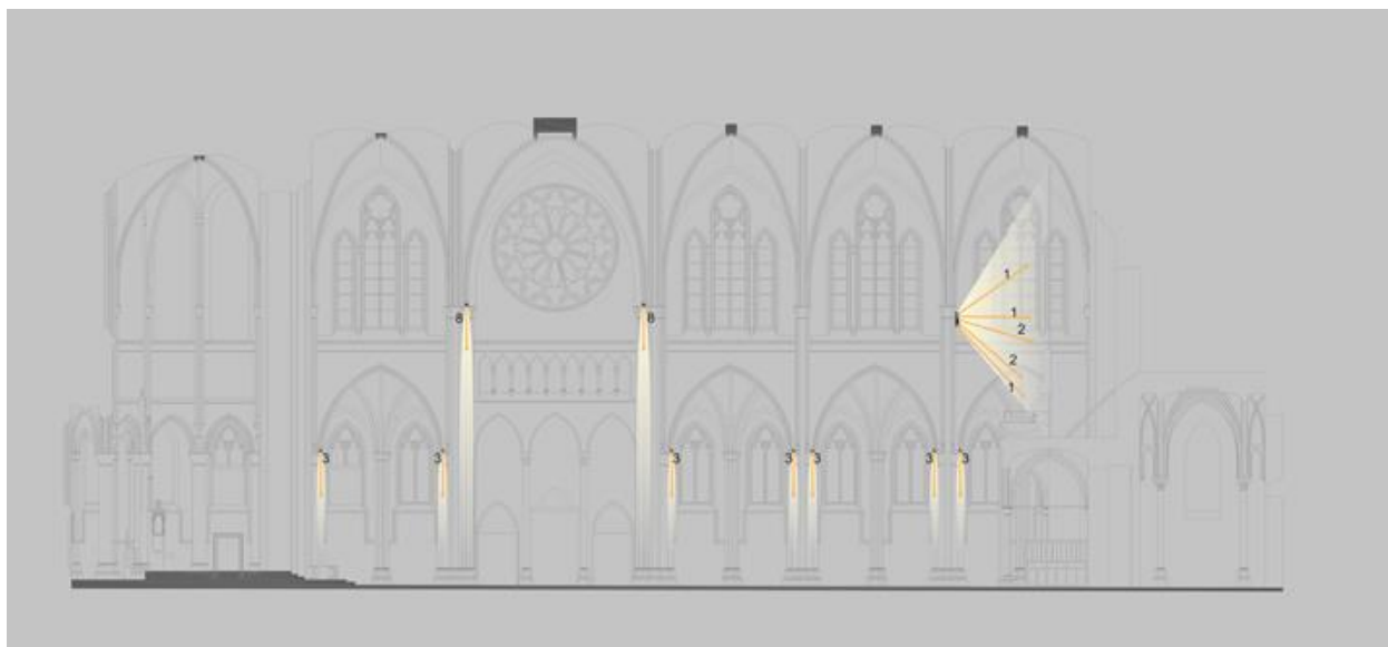
Slika 6.31 Skica načelnih pozicija rasvjetnih tijela sa usmjerenjima snopova svjetlosti, za rasvjetu stupova, te kora i orgulja
