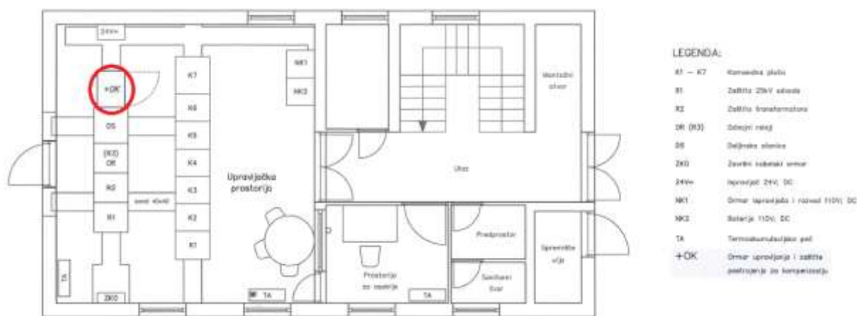
Slika 13.1 Raspored opreme u prizemlju zgrade 25 kV postrojenja u EVP 110/25 kV
