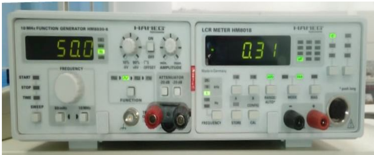
Slika 3.2. Funkcijski generator HM 8030-6
