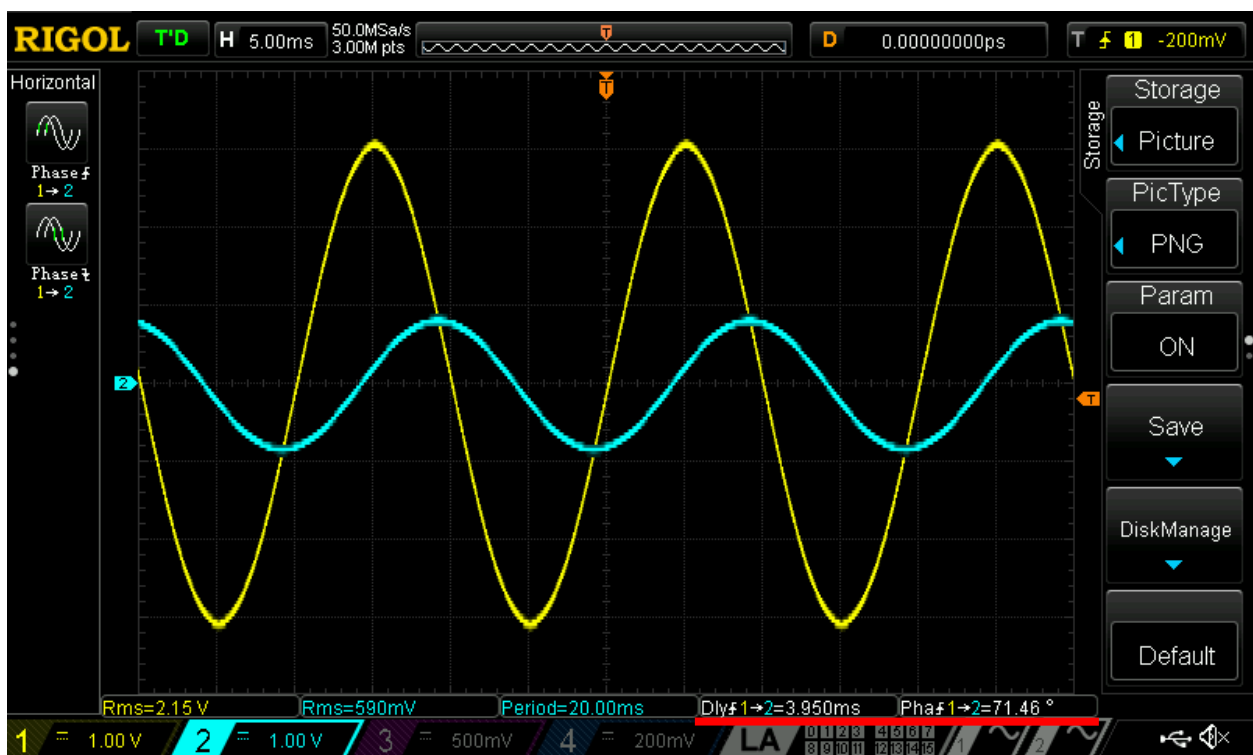
3.16. Prikaz faznog pomaka na osciloskopu
