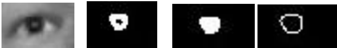
Slika 4.3. a) Područje interesa standardizirane slike (lijevo) i isto područje s obavljenom b) binarizacijom (lijevo sredina), c) morfološkim zatvaranjem (desno sredina) te, d) primjenom algoritma za pronalazak ruba (desno)
