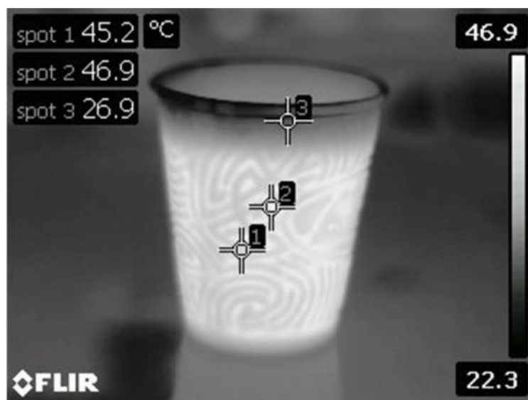
Slika 3.4. 3 Primjer termograma čašice s kavom
