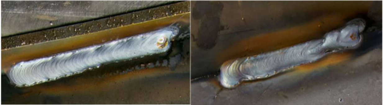
Slika 4.2.3. c) Stvarna slika u boji zavora bez defekta [22]
