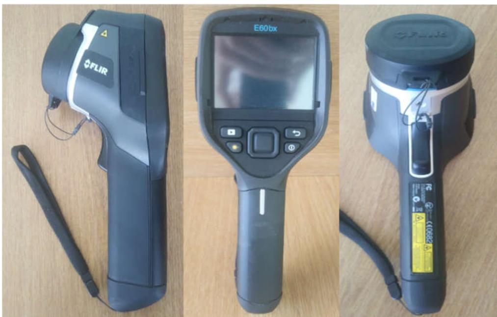
Slika 3.4. 1 IC kamera FLIR E60bx
