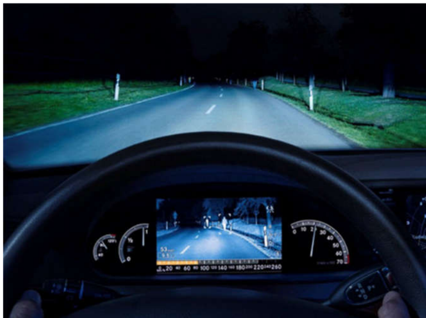
Slika 4.1. 1 Infracrvena kamera za noćni vid u vozilu [20]
