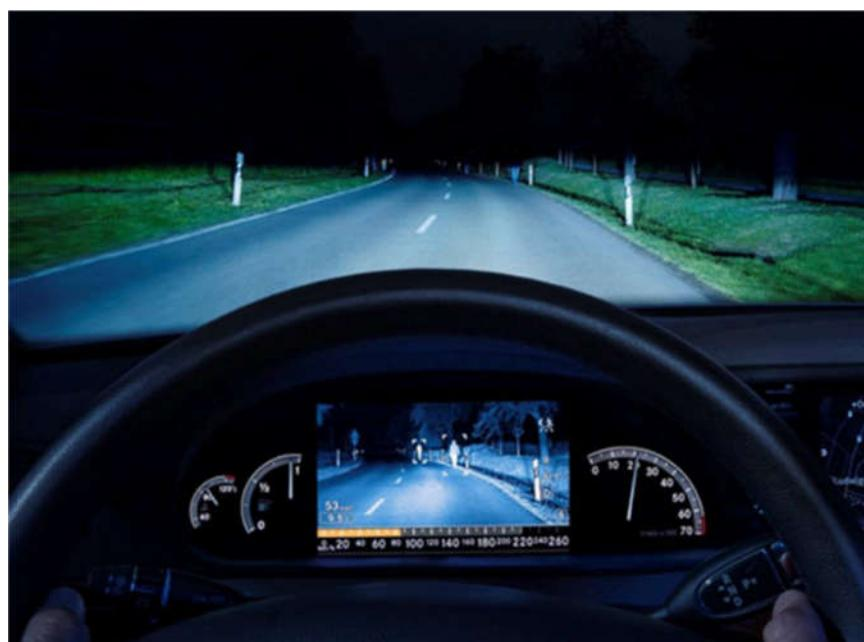
Slika 4.1. 1 Infracrvena kamera za noćni vid u vozilu [20]
