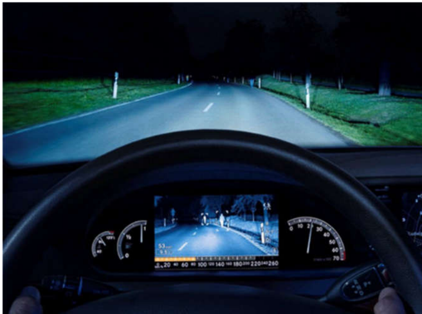
Slika 4.1. 1 Infracrvena kamera za noćni vid u vozilu [20]
