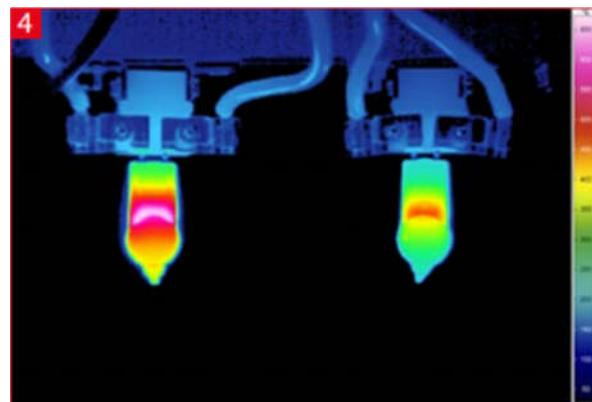
Slika 4. 5 Termogram žarulja prednjeg svjetla vozila [16]
