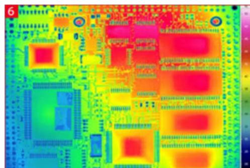
Slika 4. 6 Termogram tiskane pločice vozila [17]
