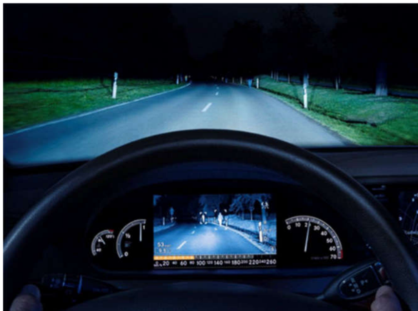
Slika 4.1. 1 Infracrvena kamera za noćni vid u vozilu [20]
