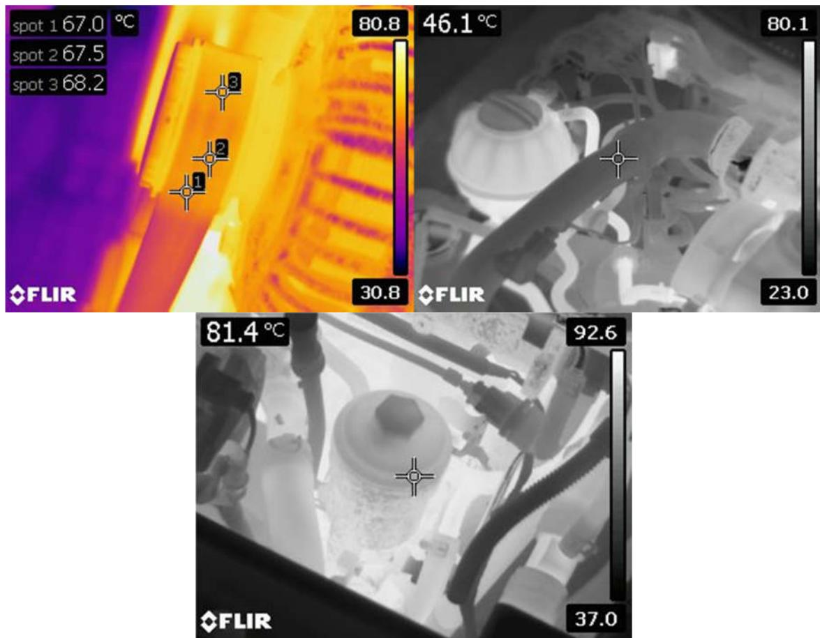
Slika 4. 2 Termogram remena, usisne grane i filtera ulja
