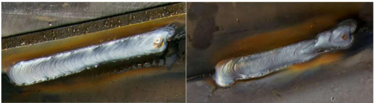
Slika 4.2.3. c) Stvarna slika u boji zavara bez defekta [22]
