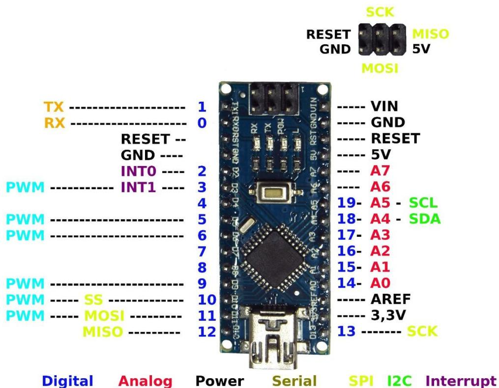
Slika 2.2 Raspored pinova mikroupravljačke pločice Arduino Nano [5]
