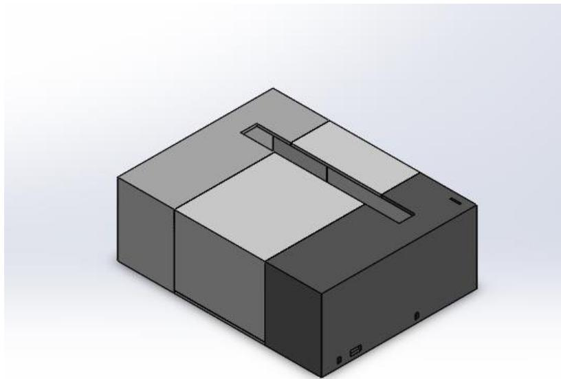
*Slika 3.1 Kućište digitalnog difraktometra*
