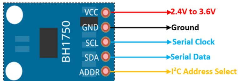
Slika 2.4 Raspored pinova senzora svjetlosti BH1750 [8]
