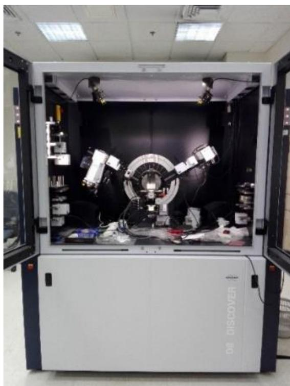
Slika 2.1 Difraktometar X – zraka Bruker D8 [3]
