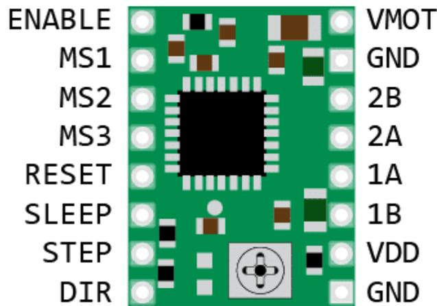
Slika 2.6 Raspored pinova na upravljaču koračnog motora A4988 [11]
