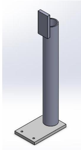
*Slika 3.4 Nosač senzora*
