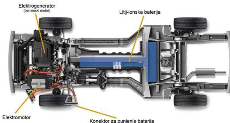
Slika 3.2 Dijelovi pogonskog sustava EREV vozila [3]
