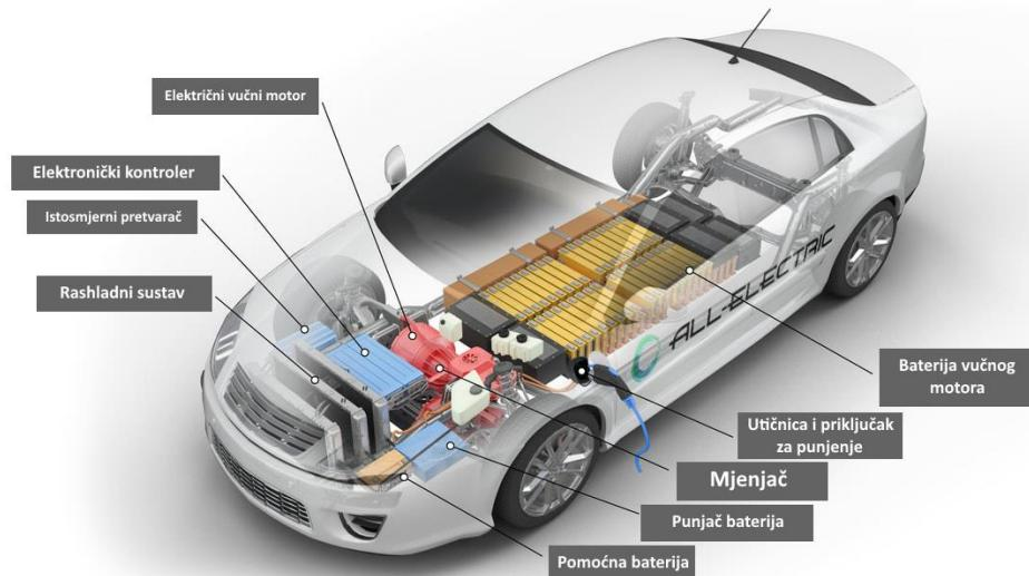
Slika 3.3 Pogonski sustav potpuno električnog vozila [6]
