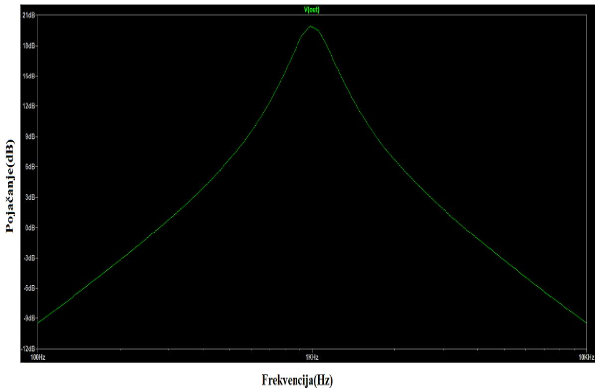
**Slika 5.3** Amplitudno-frekvencijska karakteristika aktivnog pojasnog propusnog filtra *MFB* topologije za  $Q=3$
