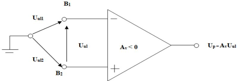
**Slika 2.1** Shematski prikaz operacijskog pojačala [1]
