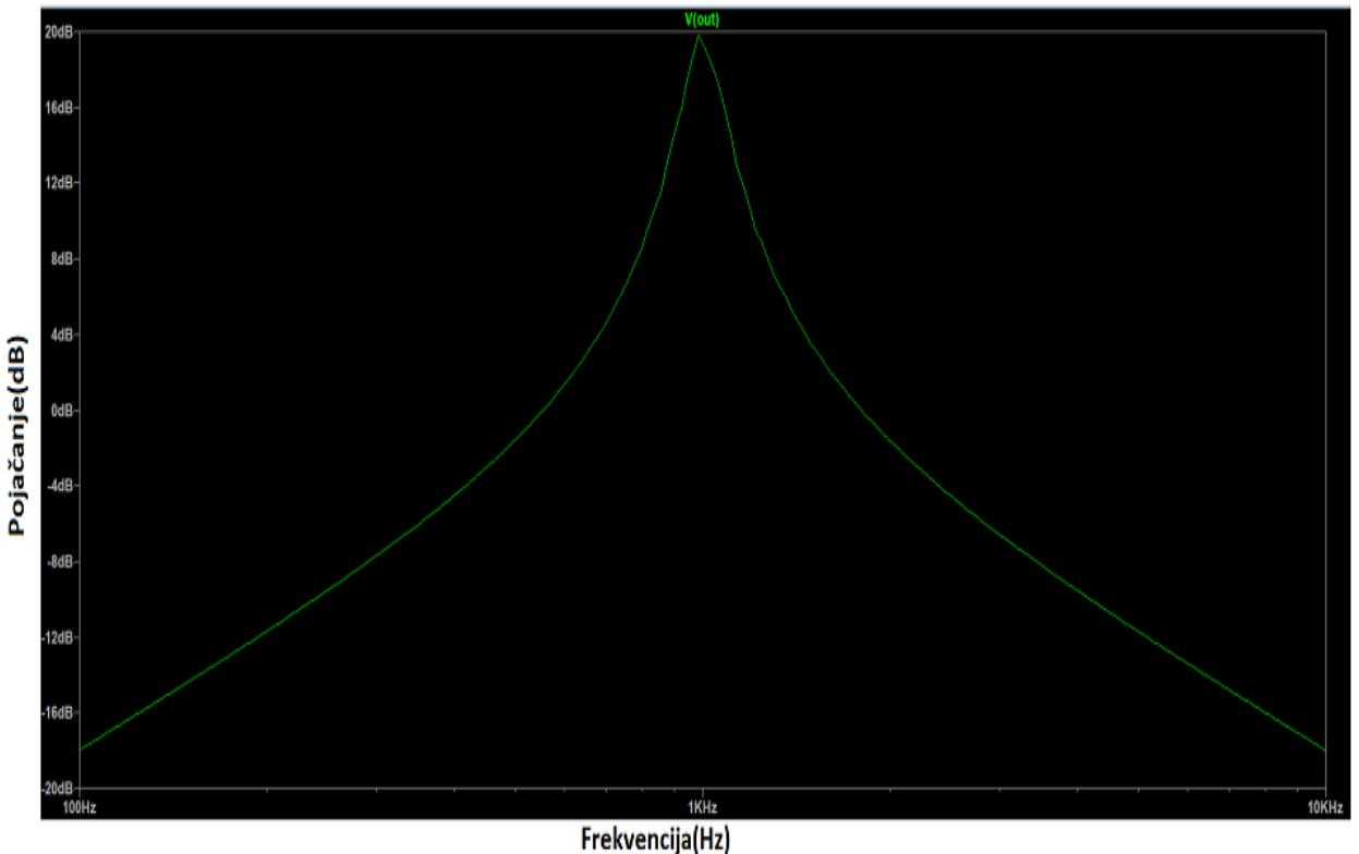
**Slika 5.2** Amplitudno-frekvencijska karakteristika aktivnog pojасног пропусног филтера *MFB* топологије за  $Q=8$
