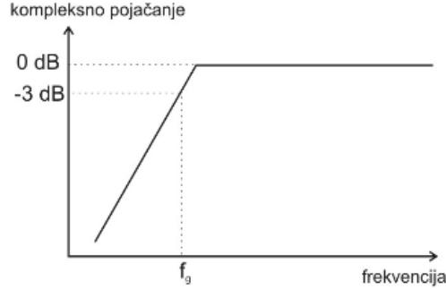
**Slika 3.5** Frekvencijska karakteristika visokopropusnog filtra (CR) [6]
