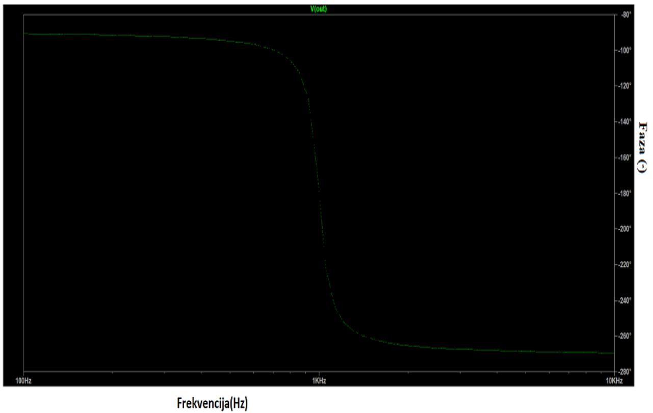
**Slika 5.4** Fazno-frekvencijska karakteristika aktivnog pojasno propusnog filtra *MFB* topologije za
