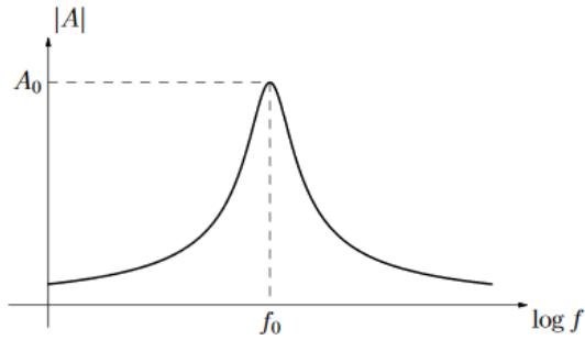
**Slika 3.9** Amplitudno-fazna karakteristika uskopojasnog filtra [8]
