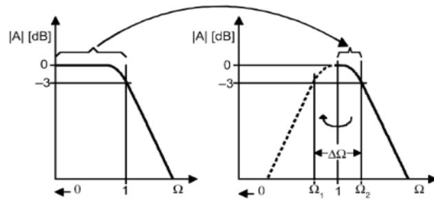
Slika 3.8 Amplitudno-frekvencijska karakteristika pojednostavljenog propusnog filtra [9]
