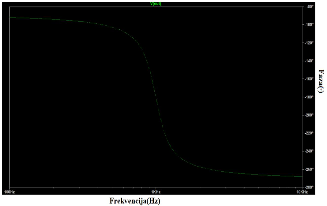
**Slika 5.5** Fazno-frekvencijska karakteristika aktivnog pojednostavljenog filtra MFB topologije za  $Q=3$
