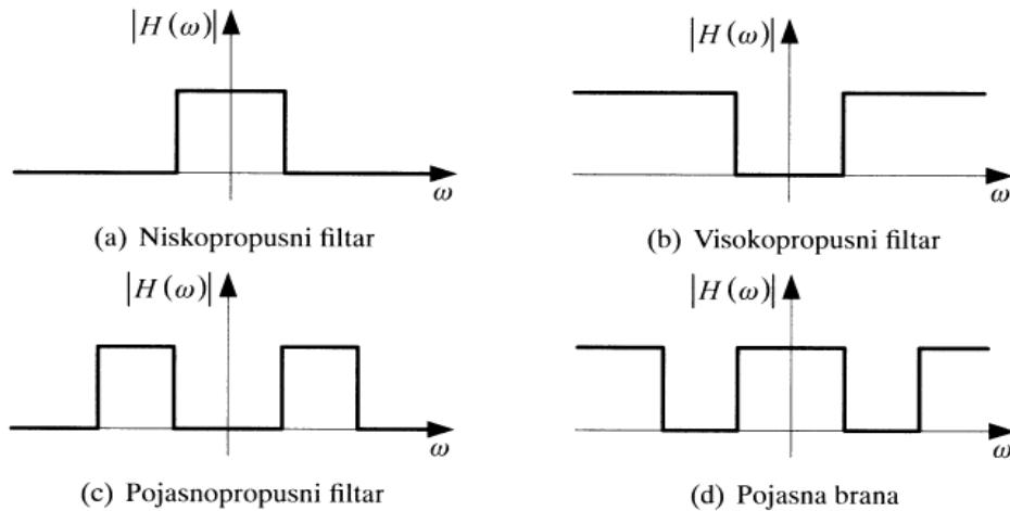
Slika 3.1 Amplitudno-frekvencijske karakteristike filtera [7]
