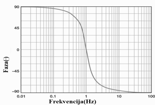
**Slika 3.11** Fazno-frekvencijska karakteristika pojednostavljenog filtra [6]
