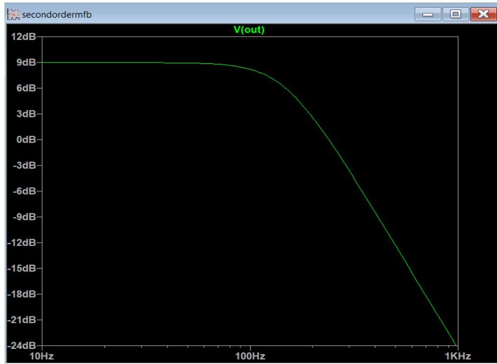
**Slika 6.7.** Amplitudno-frekvencijska karakteristika MFB filtra
