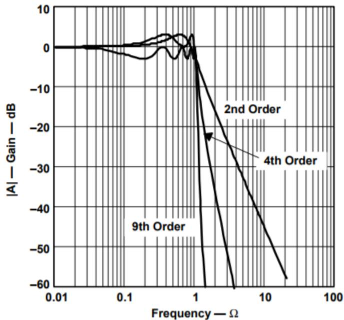
Slika 5.2. Amplitudna karakteristika Čebiševljev niskopropusnih filtrov i-tog reda [10]
