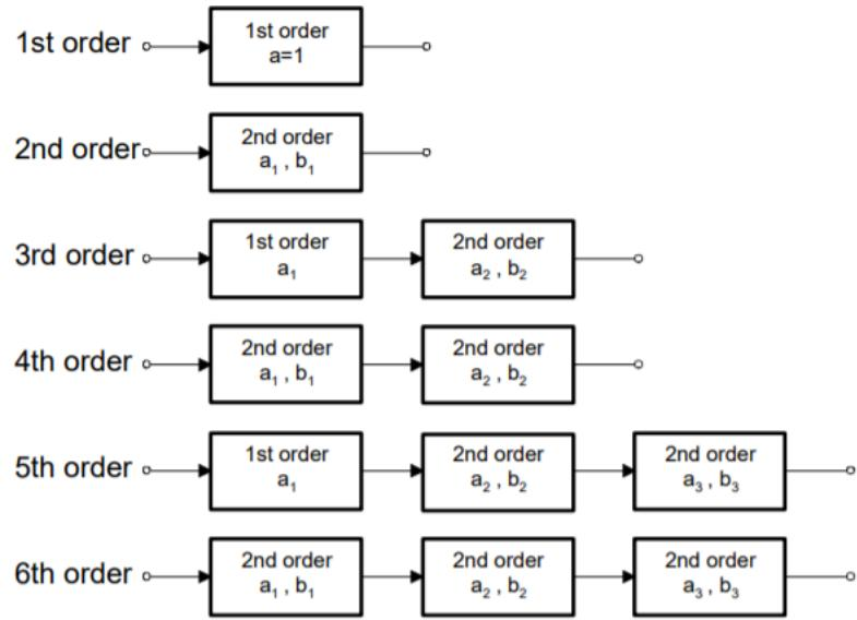
**Slika 5.5.** Kaskadno spajanje filtera višeg reda [10]
