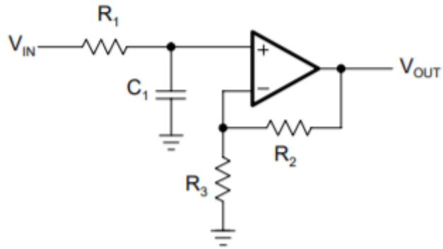
**Slika 5.6.** Neinvertirajući niskopropusni filter prvog reda [10]
