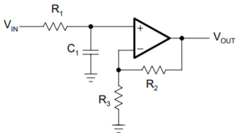
**Slika 4.2.** Neinvertirajući niskopropusni filter prvog reda [10]
