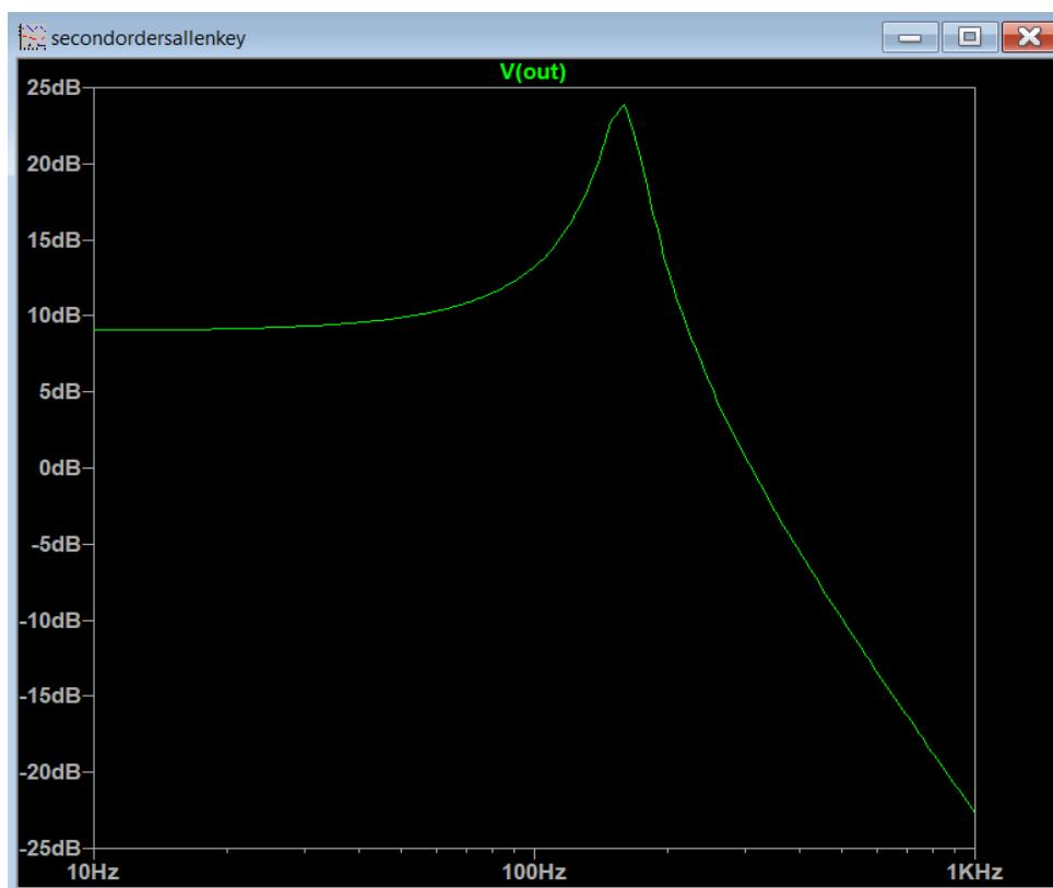
Slika 6.4. Amplitudno-frekvencijska karakteristika Sallen-Key filtra s  $Q=5$
