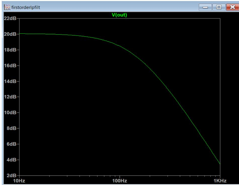
**Slika 6.2.** Amplitudno-frekvencijska karakteristika niskopropusnog filtra prvog reda
