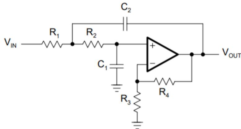
**Slika 5.8.** Sallen-Key niskopropusni filter [10]
