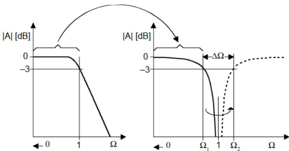
**Slika 4.9.** Prijelaz iz niskopropusnog filtra u pojasnu branu [8]
