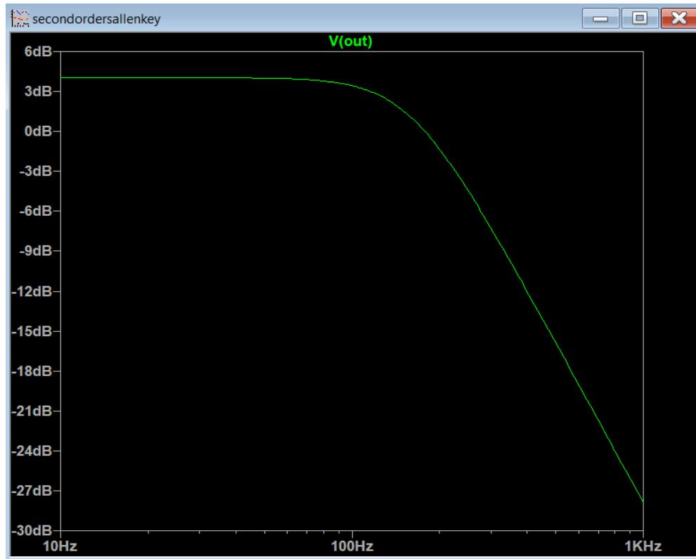
**Slika 6.5.** Amplitudno-frekvencijska karakteristika Sallen-Key filtra s  $Q=0.7$
