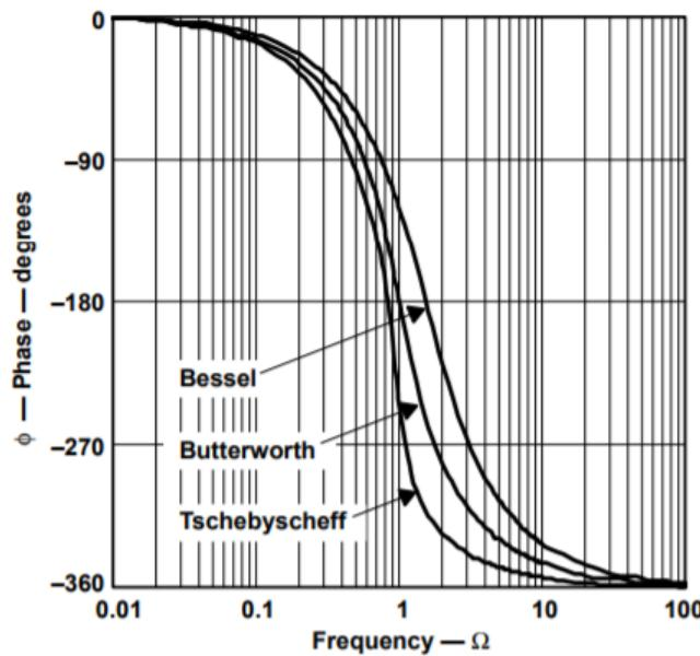
Slika 5.3. Usporedba faznih karakteristika filtara četvrtog reda
