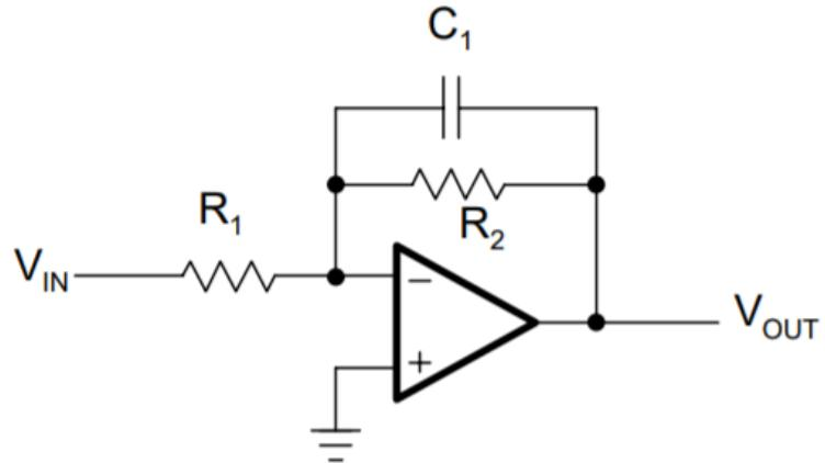
**Slika 5.7.** Invertirajući niskopropusni filter prvog reda [10]
