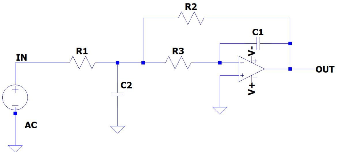
**Slika 6.6.** Model Multiple Feedback niskopropusnog filtra drugog reda
