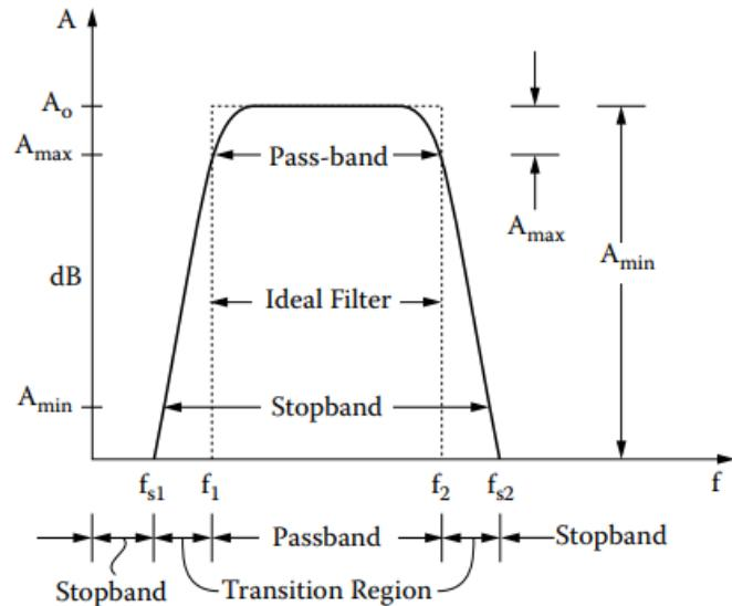
**Slika 4.5.** Amplitudna karakteristika pojASNopropusnog filtra [8]
