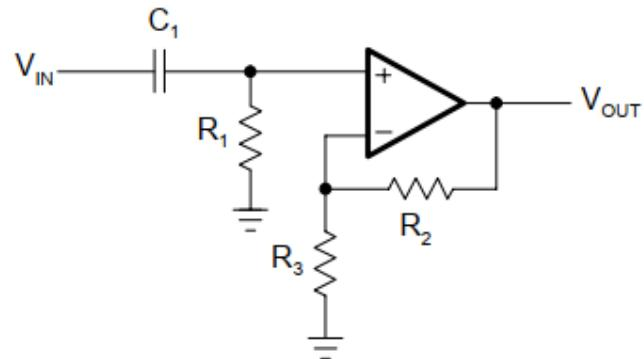
Slika 4.4. Neinvertirajući visokopropusni filter prvog reda [10]
