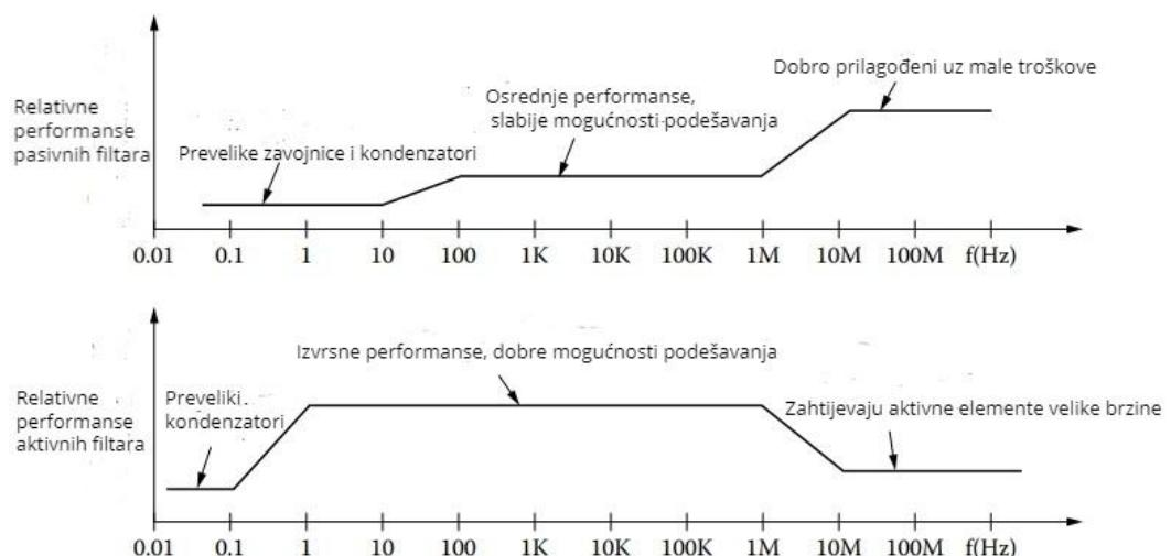
**Slika 3.1. Usporedba pasivnih i aktivnih filtera [8]**
