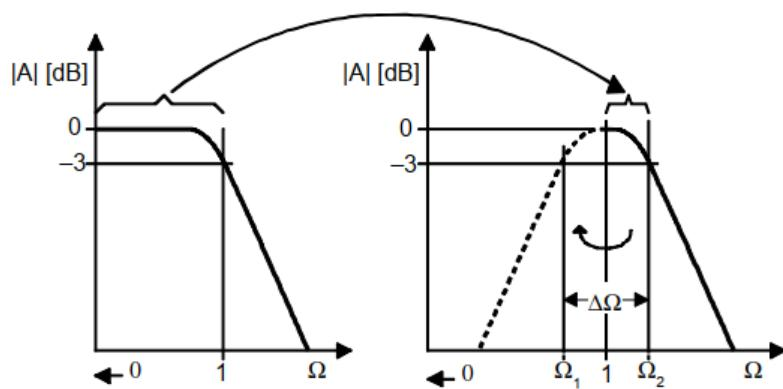
**Slika 4.6.** Prijelaz iz niskopropusnog u pojASNopropusni filter [8]
