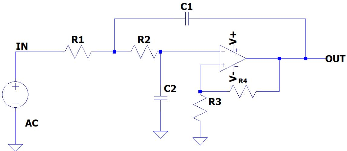
**Slika 6.3.** Model Sallen-Key niskopropusnog filtra drugog reda
