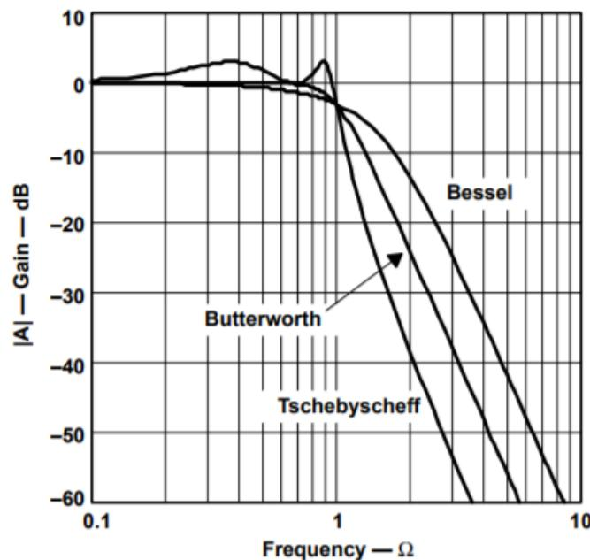
Slika 5.4. Usporedba amplitudnih karakteristika filtara četvrtog reda [10]
