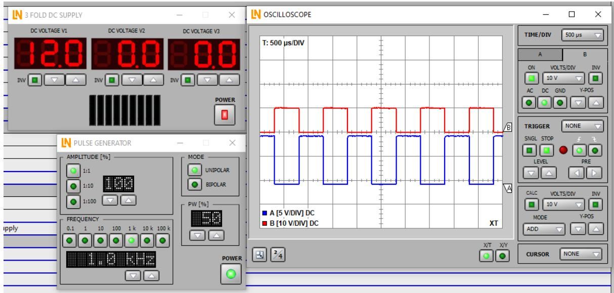
Slika 4.15. Upravljački (plavo) i izlazni (crveni) napon IRF820 za  $f=1\text{ kHz}$
