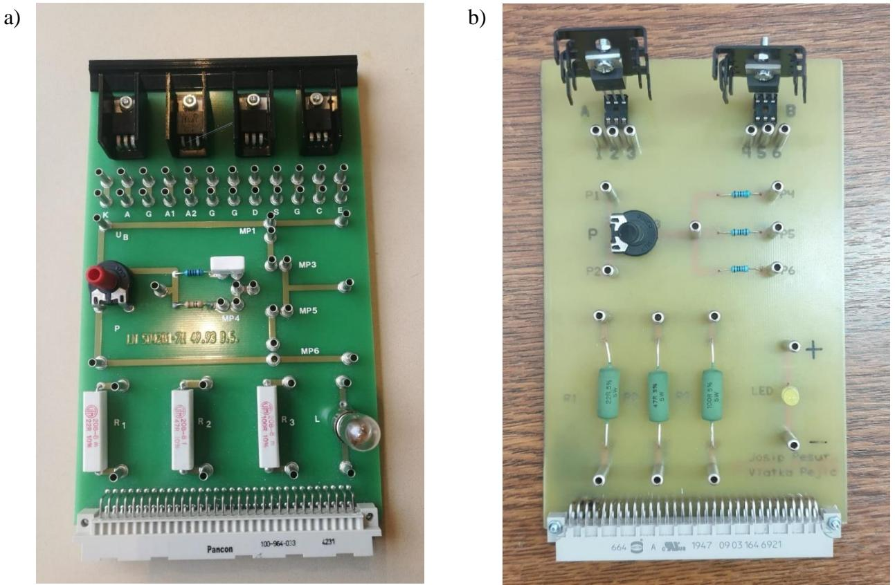
*Slika 4.5. Prikaz pločica s poluvodičkim sklopnim komponentama: a) Lucas-Nuelle pločica,
