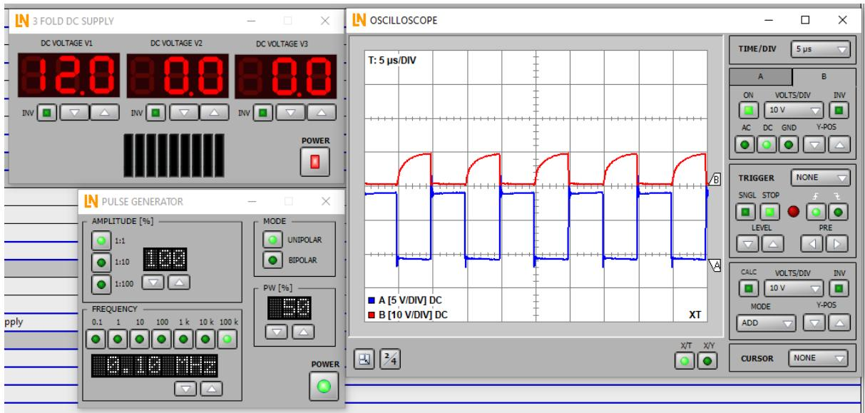
Slika 4.22. Upravljački (plavo) i izlazni (crveni) napon IGBT FGP-tipa za  $f=100\text{ kHz}$ .
