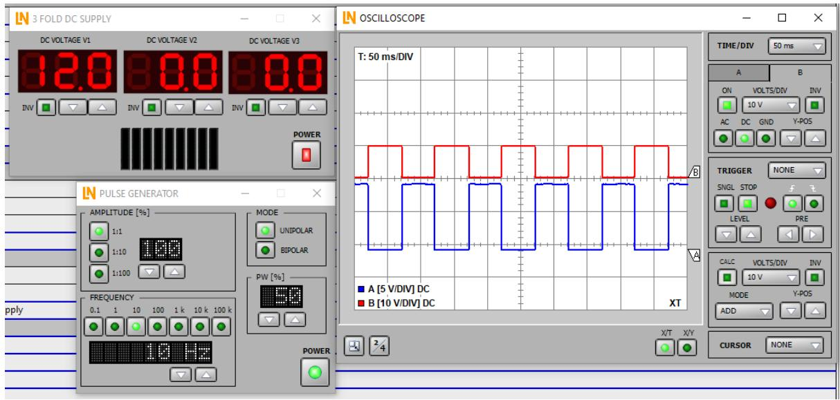
Slika 4.14. Upravljački (plavo) i izlazni (crveno) napon FGP-tipa IGBT-a za  $f=10\text{ Hz}$
