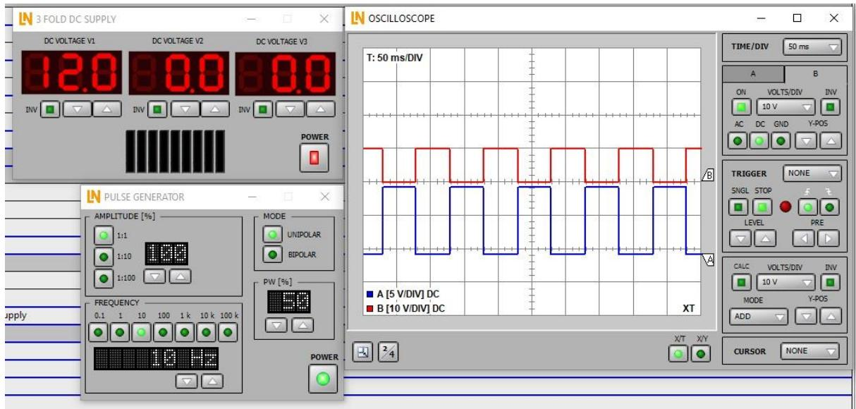
Slika 4.13. Upravljački (plavo) i izlazni (crveni) napon IRF820 za  $f=10\text{ Hz}$
