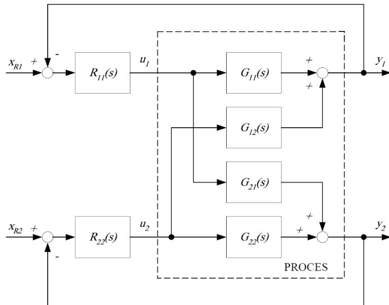
**Slika 2.3.** Blokovaška shema  $2 \times 2$  sustava.
