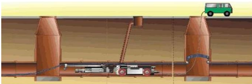
Slika 5.6. Postavljanje kabela pomoću robota
