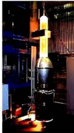
Slika 5.3. Postupak aksijalne depozicije [2].
