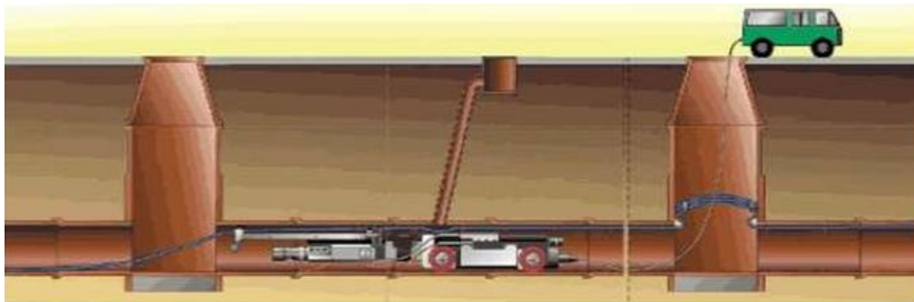
Slika 5.6. Postavljanje kabela pomoću robota
