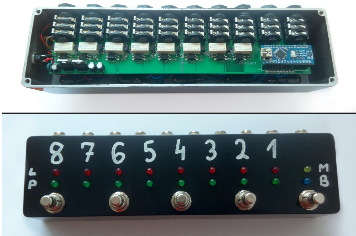
Slika 5.10. Završeni uređaj za usmjeravanje signala kroz gitarske efekte
