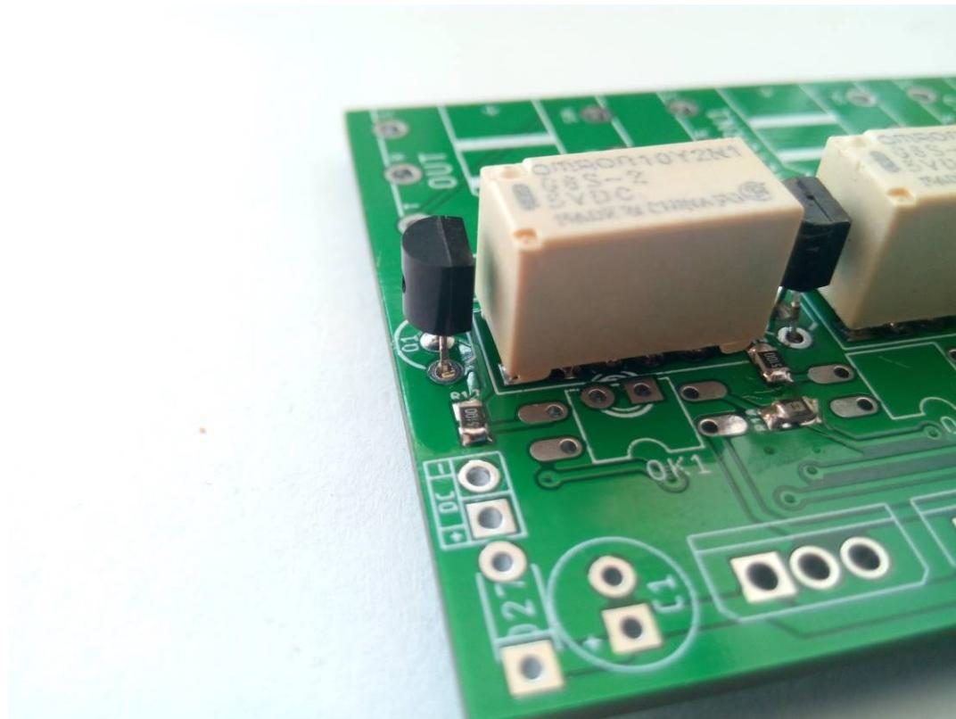
Slika 5.6. Pločica sa zalemljenim tranzistorima, SMD otpornicima i relejima
