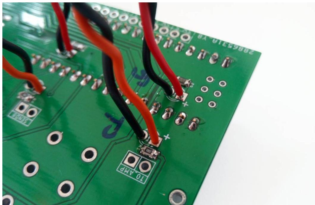
**Slika 5.8.** Diode i konektori žicama povezani s tiskanom pločicom
