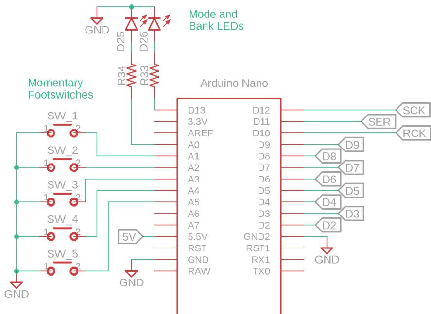
**Slika 5.1.** Shema spajanja mikroupravljača
