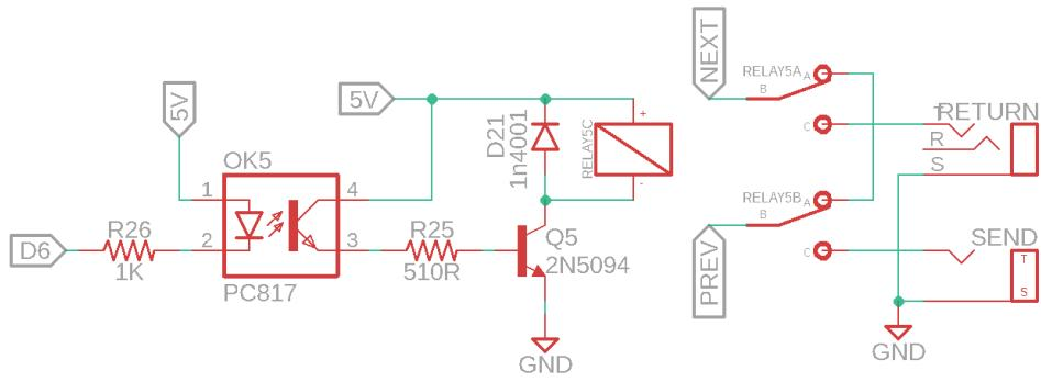
**Slika 5.3.** Shema spajanja releja i optoizolatora
