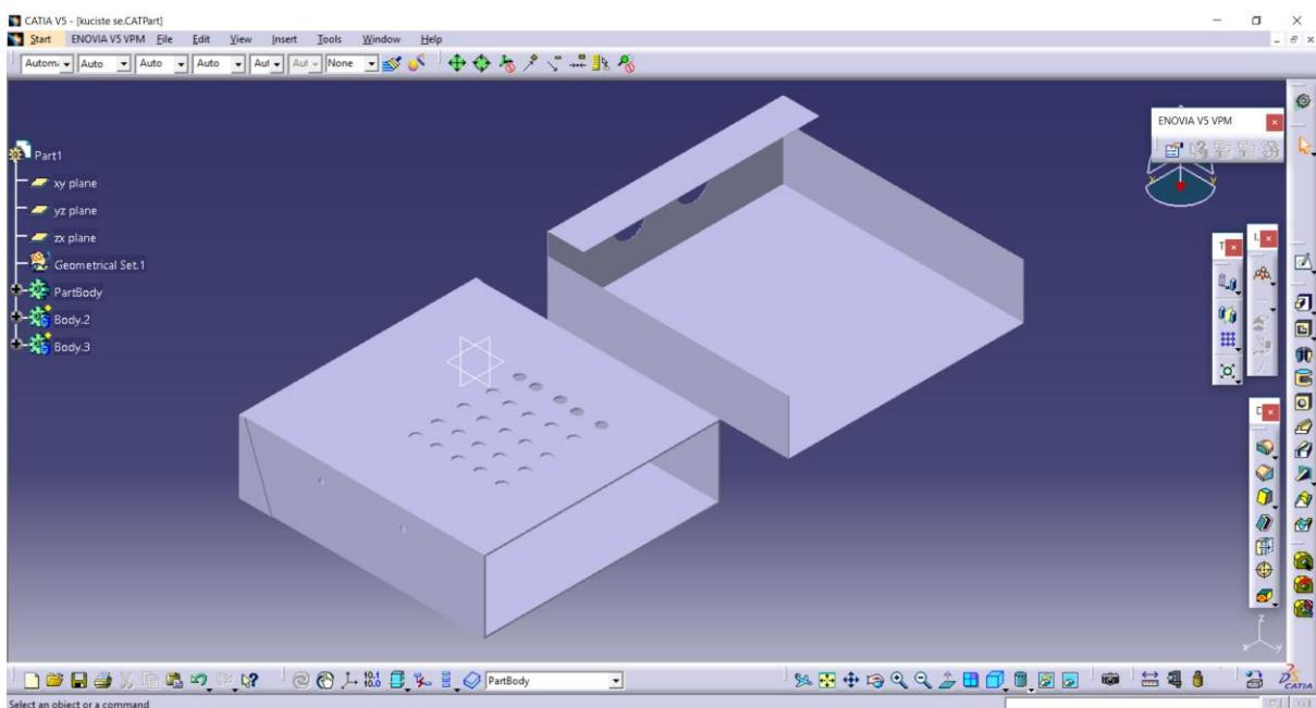
Slika 3.8. 3D model senzorskog kućišta
