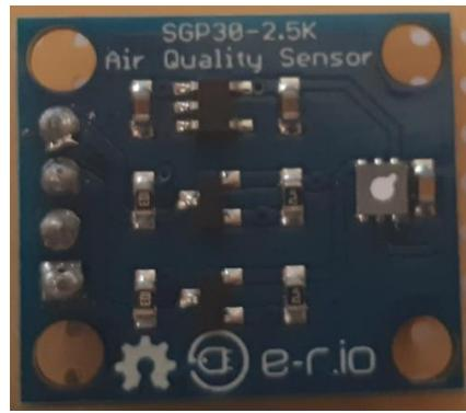
Slika 2.4. SGP30-2.5K senzor
