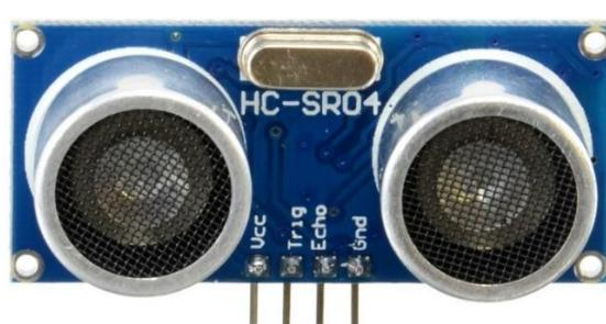
Slika 2.6. Ultrazvučni modul HC-SR04 [9]
