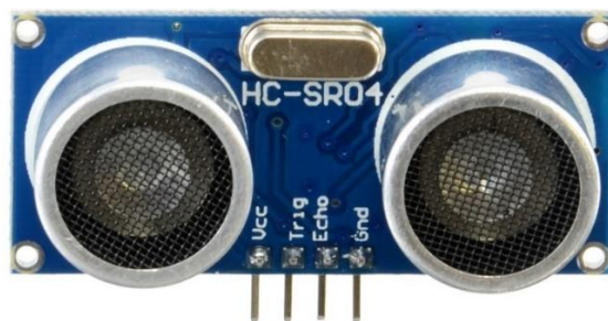
Slika 2.6. Ultrazvučni modul HC-SR04 [9]
