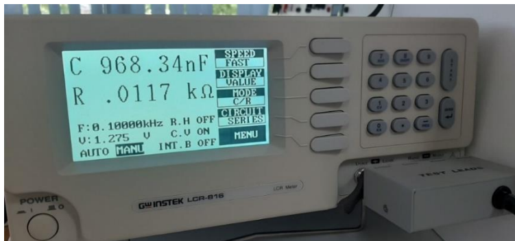
Slika 4. 21. Prikaz odabranih postavki pri mjerenju parametara u serijskom nadomjesnom spoju.
