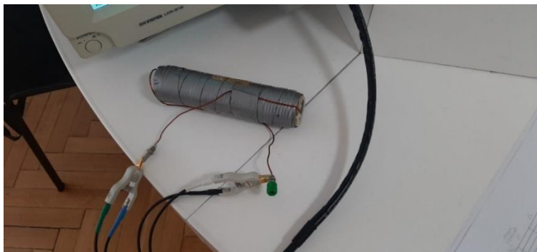
Slika 4. 15. Način spajanja priključaka instrumenta na zavojnicu nazivnog induktiviteta 0,45[mH] .
