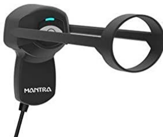
Slika 3.5. Prijenosni uređaj za skeniranje šarenice (preuzeto s www.mantratec.com )
