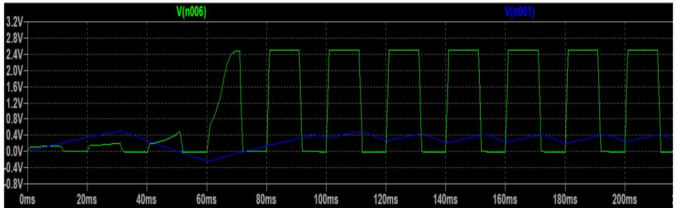
*Slika 4.3. Prikaz napona memristora (zeleno) i napona na kondenzatoru (plavo)*
