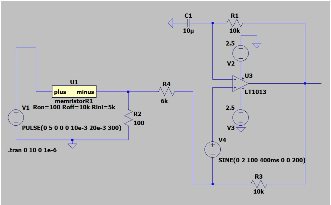
*Slika 4.2. Shema spoja u izvedbi s Bielek memristorom*
