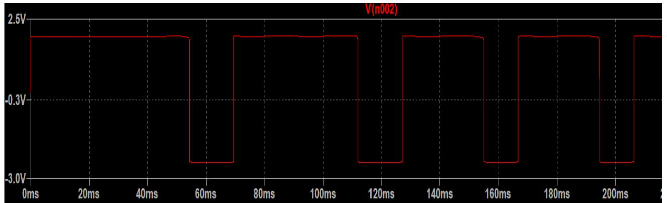
*Slika 4.7. Prikaz signala na izlazu iz operacijskog pojačala*
