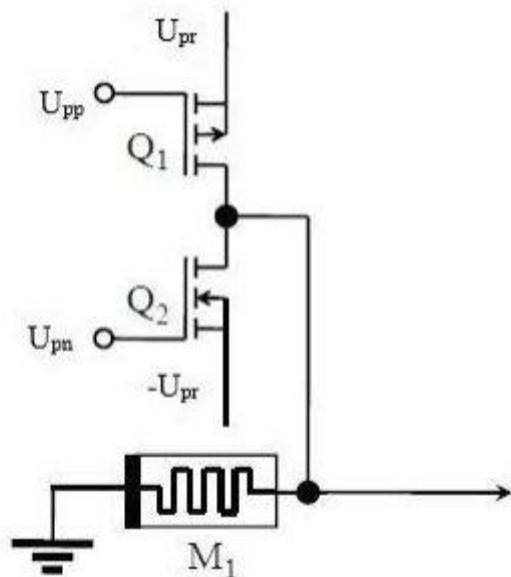
*Slika 3.3. Osnovni upravljački sklop memristora u izvedbi s 2 FET-a [9]*
