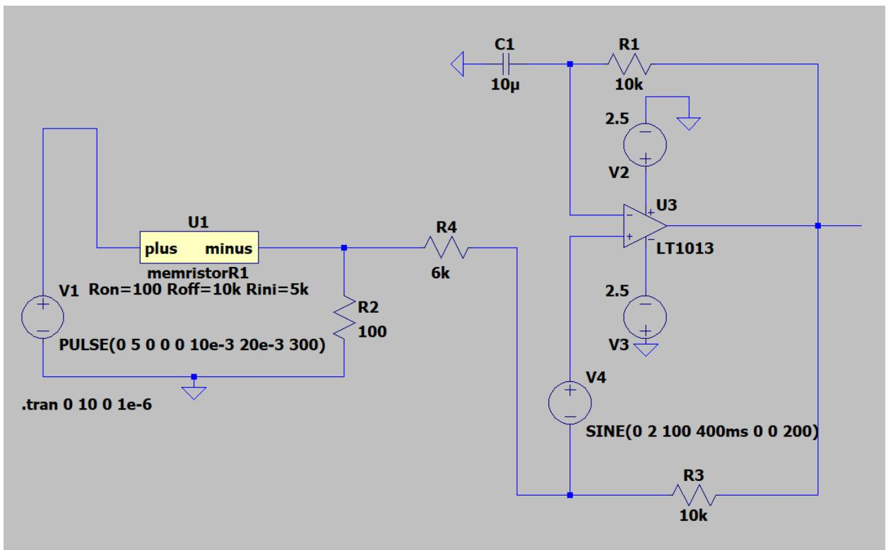
*Slika 4.1. Shema programabilnog oscilatora u izvedbi s memristorom*
