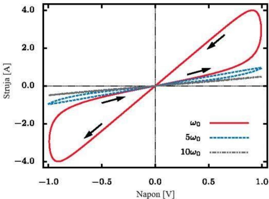
Slika 3.3. Strujno – naponska karakteristika memristora [4]
