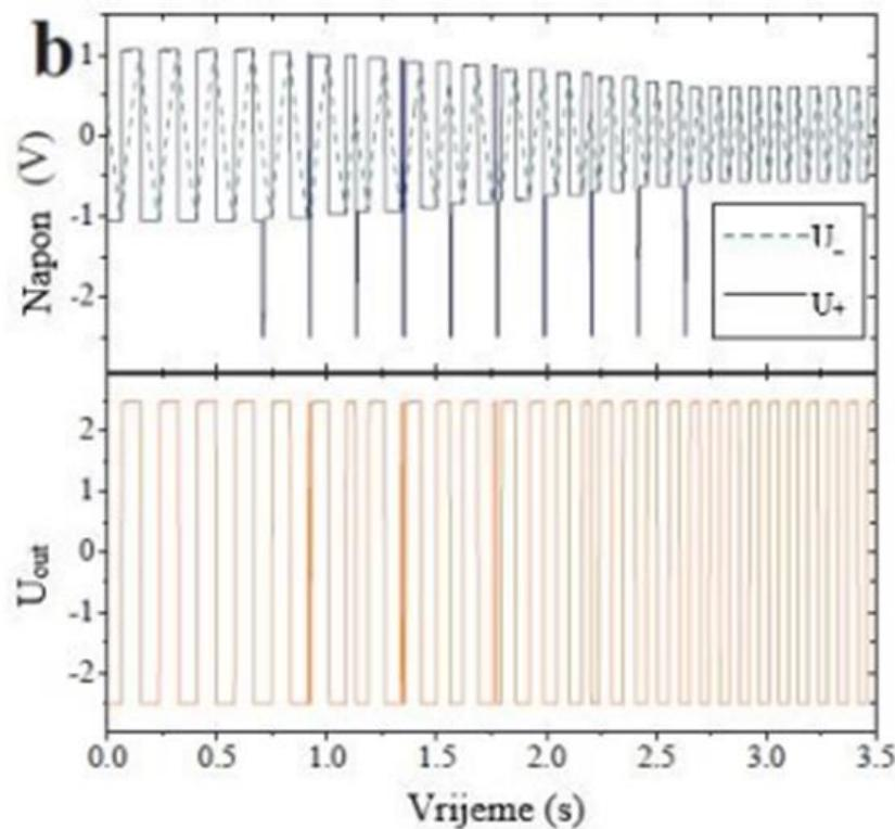
*Slika 3.4.b. Prikaz signala programabilnog oscilatora [9]*
