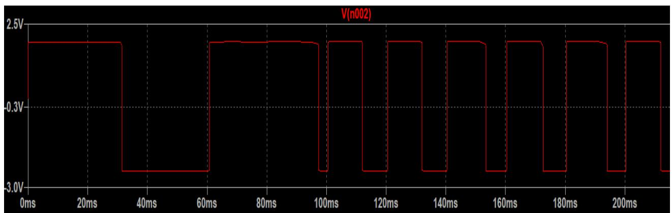
*Slika 4.4. Prikaz signala na izlazu iz operacijskog pojačala*
