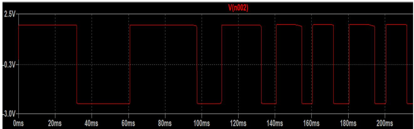
*Slika 4.10. Prikaz signala na izlazu iz operacijskog pojačala*
