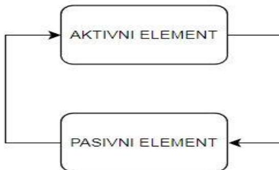
*Slika 2.3. Primjer oscilatora sa negativnim otporom[2]*
