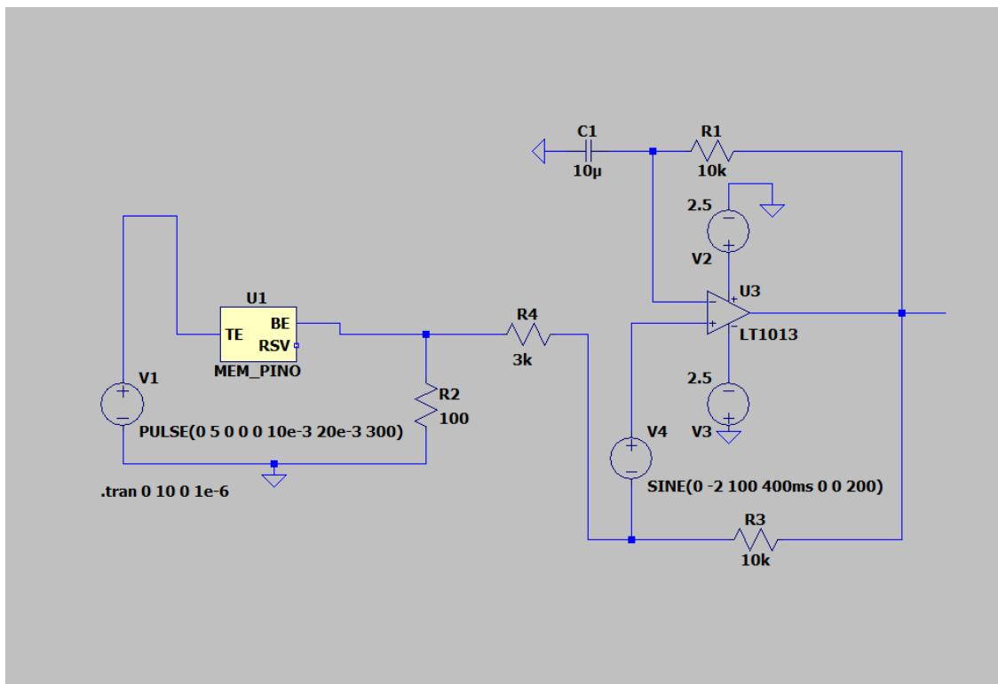
*Slika 4.8. Shema spoja u izvedbi s Pino memristorom*
