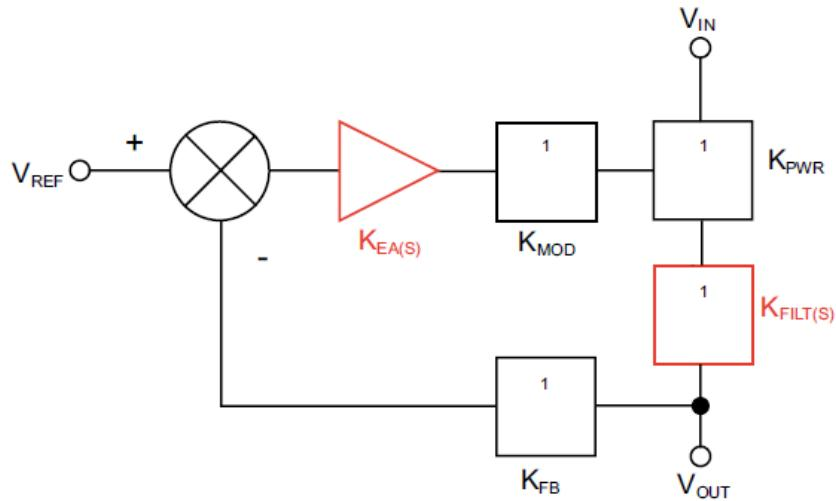
**Slika 2.7.** Blok-shema „buck“ pretvarača sa povratnom vezom [10]
