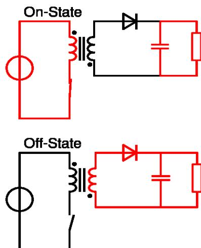
Slika 2.1. Pojednostavljena shema zapornog pretvarača [1]
