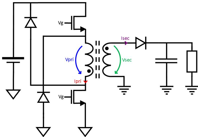
Slika 3.1. Shema zapornog pretvarača s dva tranzistora [14]
