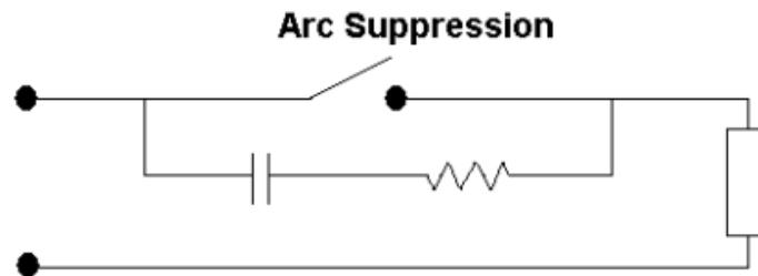
Slika 2.5. Shematski prikaz prigušnog strujnog kruga [7]
