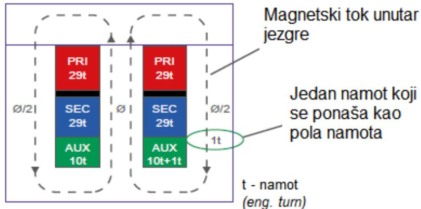
Slika 4.8. Dodavanje „pola“ namota na transformator [29]
