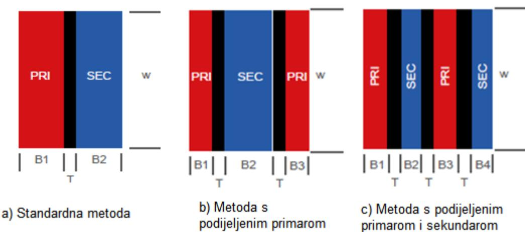
Slika 4.9. Tri metode namatanja transformatora [30]
