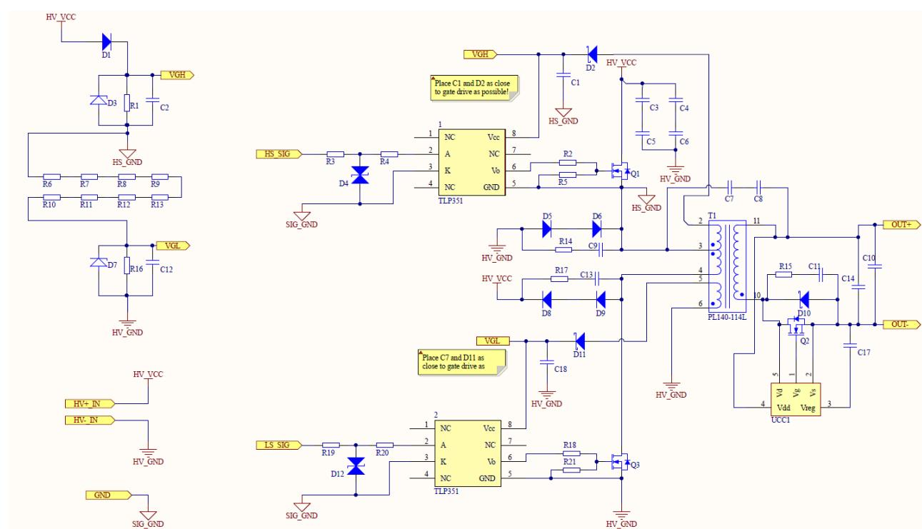
Slika 2.3. Shema korištenog zapornog pretvarača [4]
