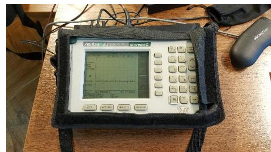
Slika 4.7. Spektralni analizator
