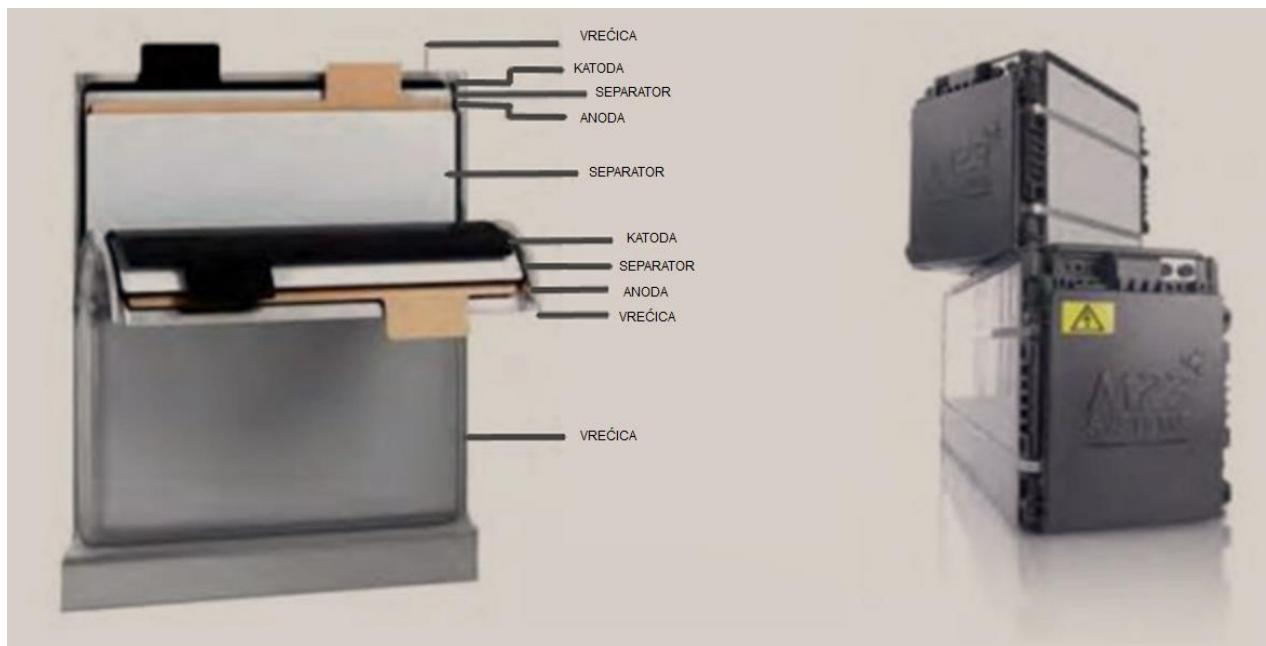
**Slika 2.5** Baterijski moduli te prizmasti dizajn litij-ionske baterije [1]
