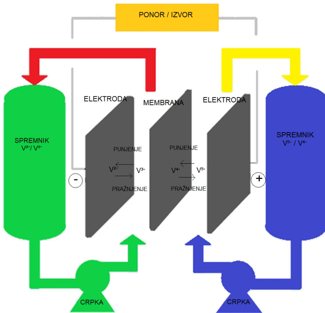
Slika 2.6 Shematski prikaz vanadiumredoks protočne baterije [1]
