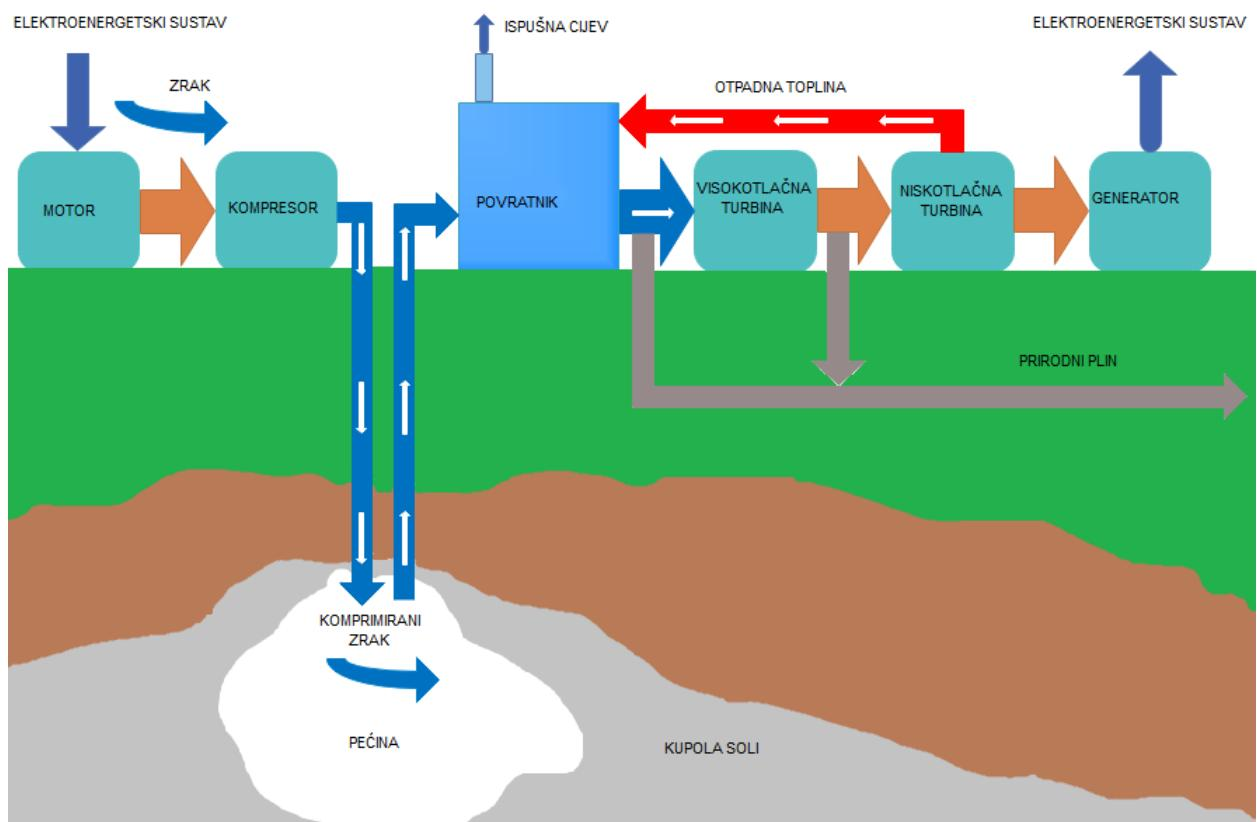
**Slika 2.2 „Sustav pohrane energije komprimiranim zrakom“ [1]**
