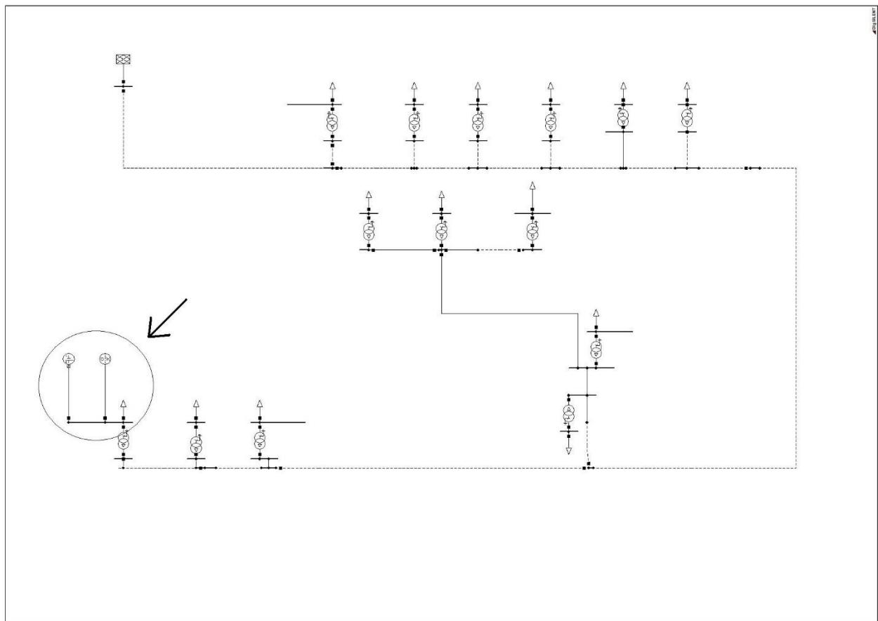
**Slika 4.9** Prikaz simulacijskog modela s baterijom i gorivom čelijom spojenima na sabirnicu 0,4 kV TM
