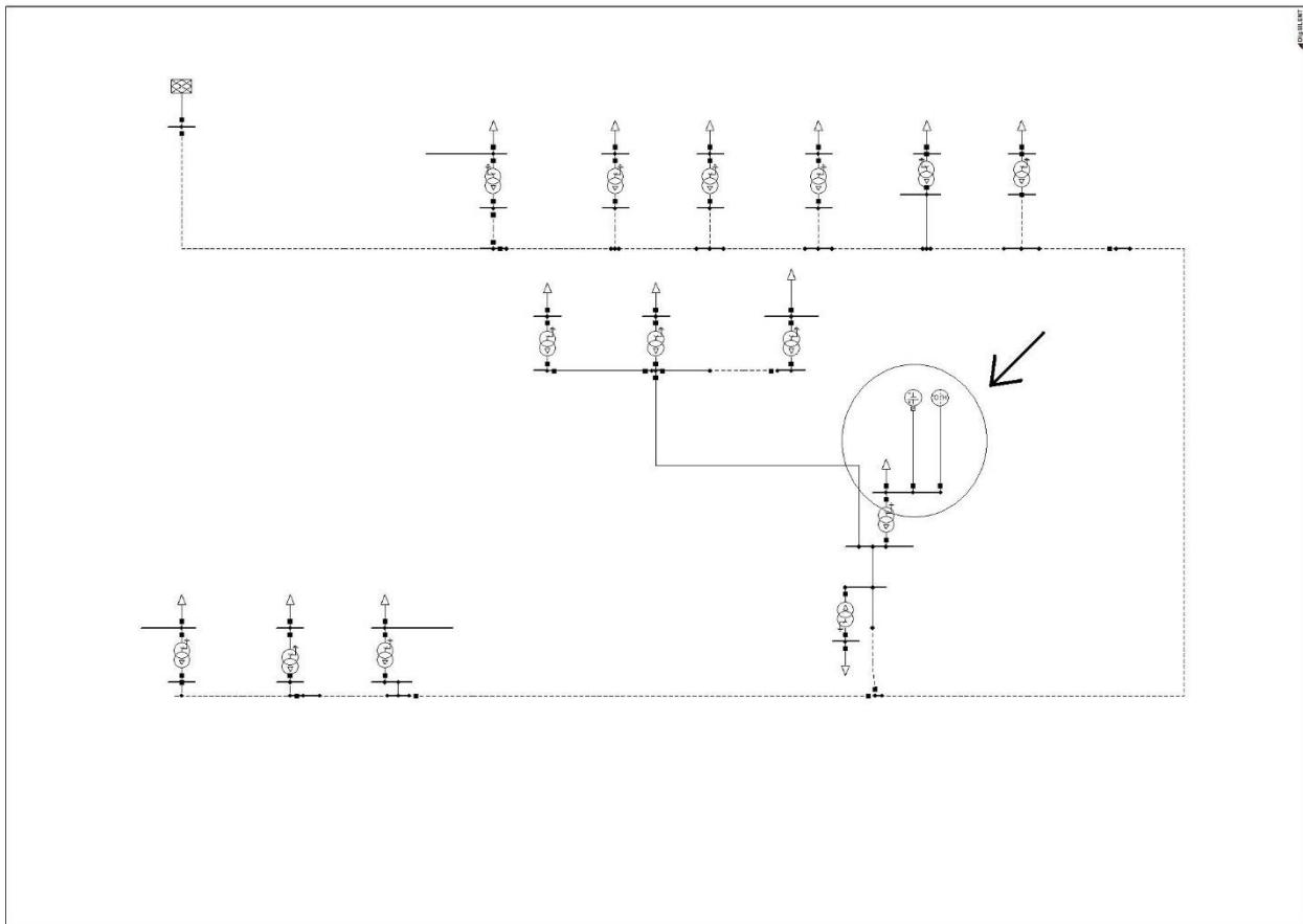
**Slika 4.6** Prikaz simulacijskog modela s baterijom i gorivom ćelijom spojenima na sabirnicu 0,4 kV Srac 5
