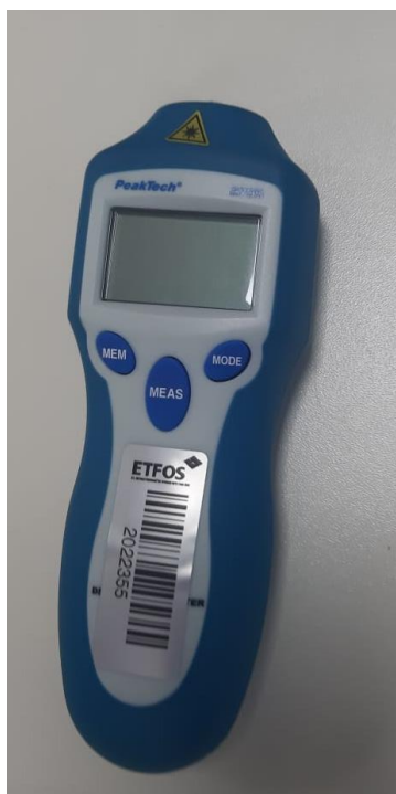
Slika 6.8. Uređaj za mjerenje brzine vrtnje ventilatora
