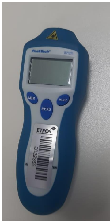
Slika 6.8. Uređaj za mjerenje brzine vrtnje ventilatora
