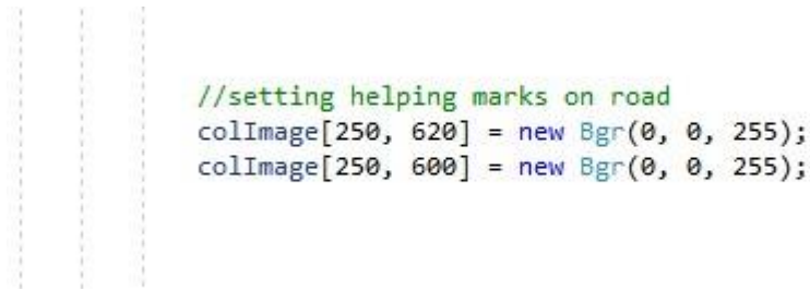
Slika 3.11 Primjer koda za postavljanje točaka
