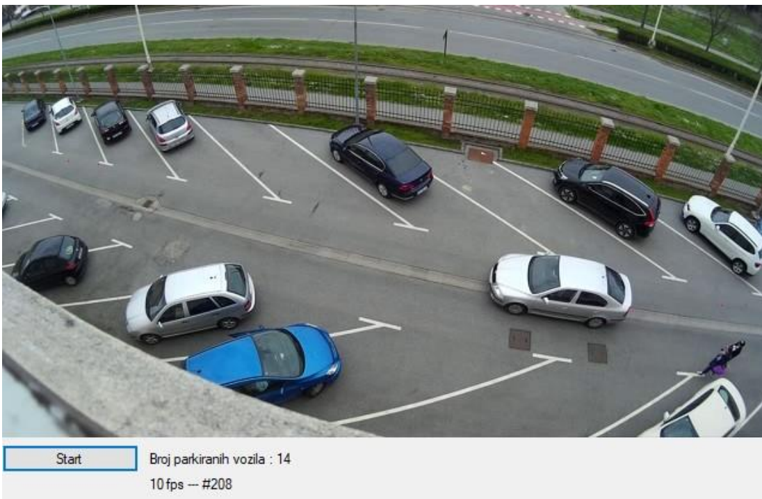
Slika 4.2 Povećanje broja parkiranih vozila dolaskom novog vozila
