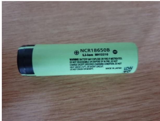
Slika 3.5. Izgled Panasonic NCR18650B baterijskog članka
