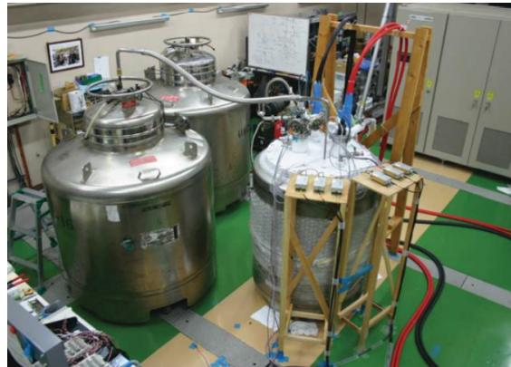
**Slika 2.17. Ilustrativna topologija SMES sustava. Tekući helij je pohranjen u spremnicima na lijevoj strani slike, dok se supravodljiva zavojnica nalazi u desnom spremniku.[1]**
