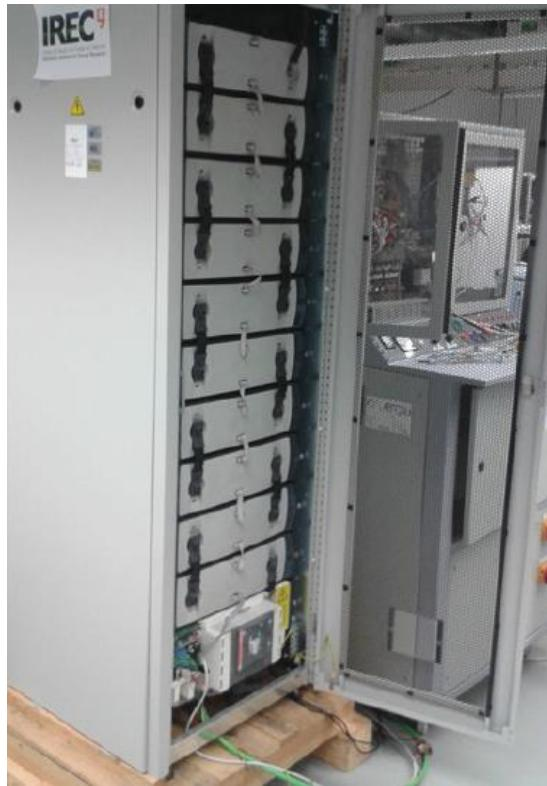
**Slika 2.11.** Litij-ionski baterijski sklop u IREC laboratoriju[1]
