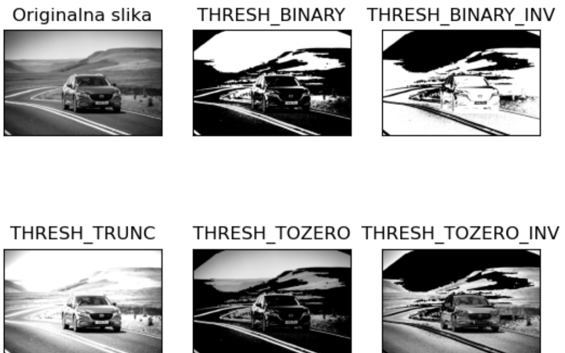
Sl. 3.3. Primjena amplitudne segmentacije s manualnim postavljanjem praga uz različite threshold_type parametre [8]
