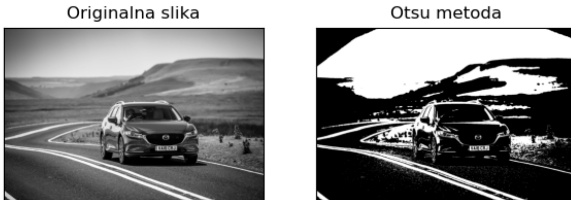
Sl. 3.7. Originalna slika i slika segmentirana Otsu metodom.
