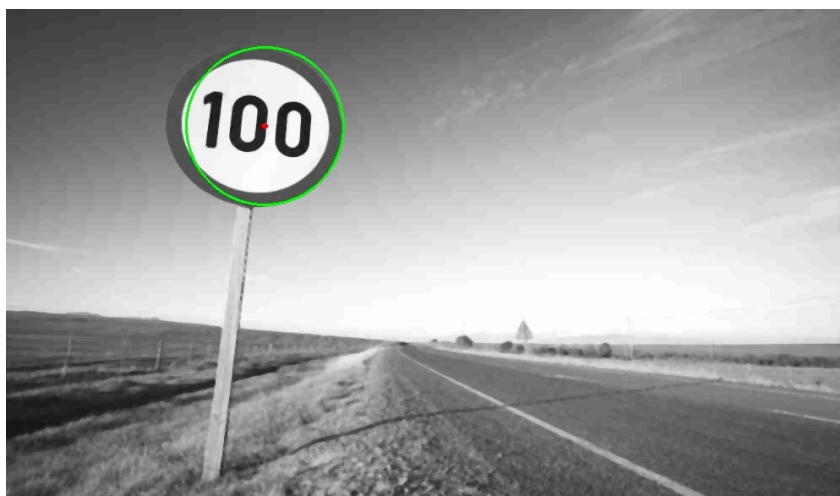
Sl. 4.19. Slika s ucrtanom detektiranom kružnicom na prometnom znaku [23]
