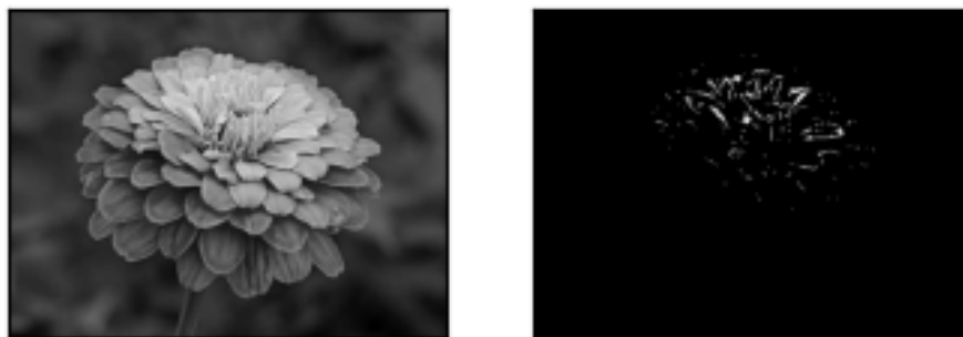
Sl. 7.3. Primjena amplitudne segmentacije s manualno postavljenim pragom. [31]
