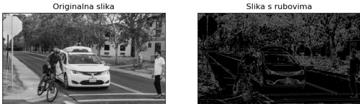
Sl. 4.10. Usporedba originalne slike i slike na kojoj je primijenjen Canny algoritam
