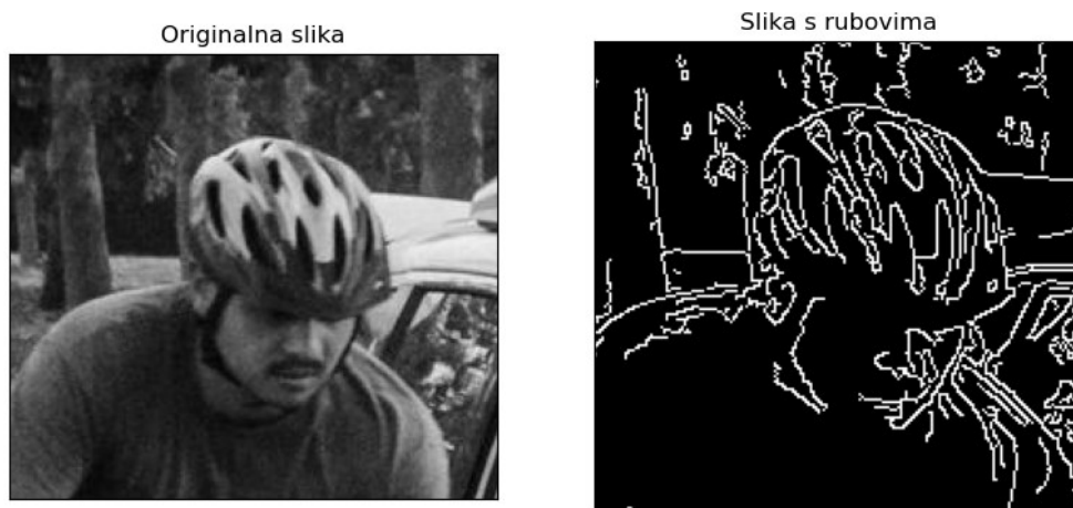
Sl. 4.11. Usporedba uvećanih dijelova sa slike 3.10. kako bi se uočila dobra lokaliziranost rubnih elemenata slike.
