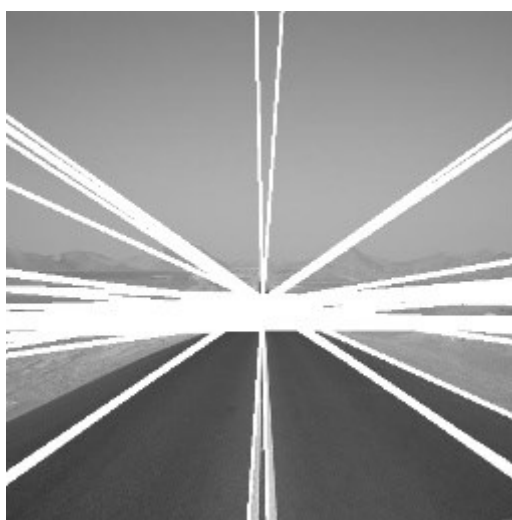
Sl. 7.23. Cesta sa slike 7.13. na kojoj su ucrtani pravci koji su nepotrebni za detekciju ceste ili pojedinih prometnih traka
